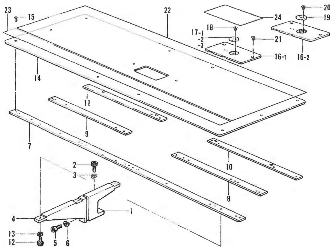
C. 針板関係 /Needle plate mechanism/Stichplattenmechanismus/
