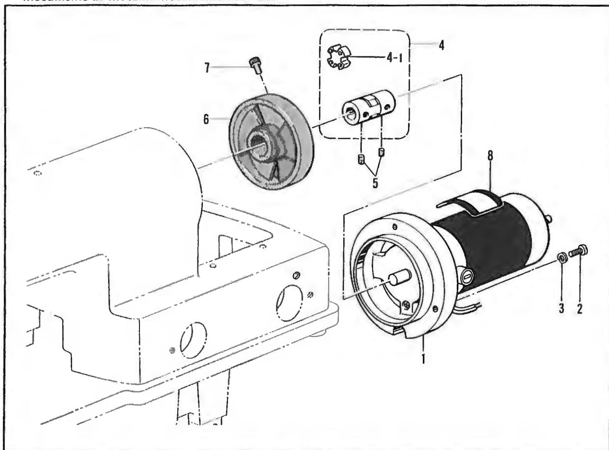
R. 踏板関係/Foot switch pedal mechanism/Fußbetätigungs/
