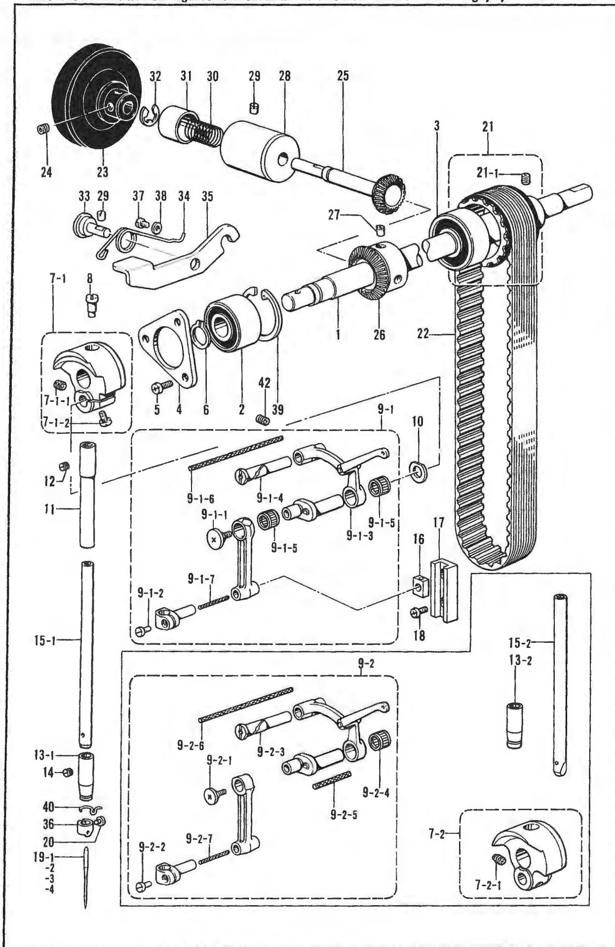
B. 鈎棒・天ビン関係 /Needle bar and thread take-up mechanism /Nadelstange und Fadenabnamevorrichtung /
