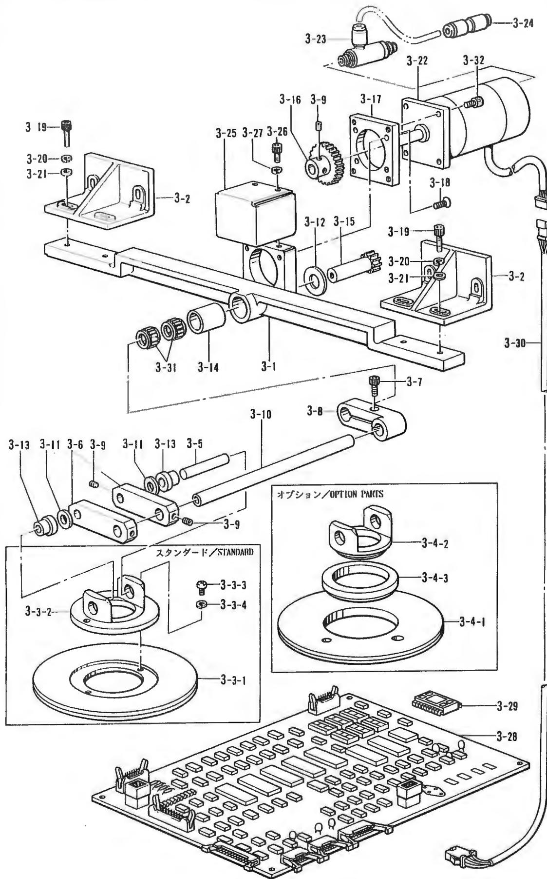
W. 反転装置関係 (オプション) / Inner clamp device mechanism (option)/Umkehrsats (Sonderzubehör)/
