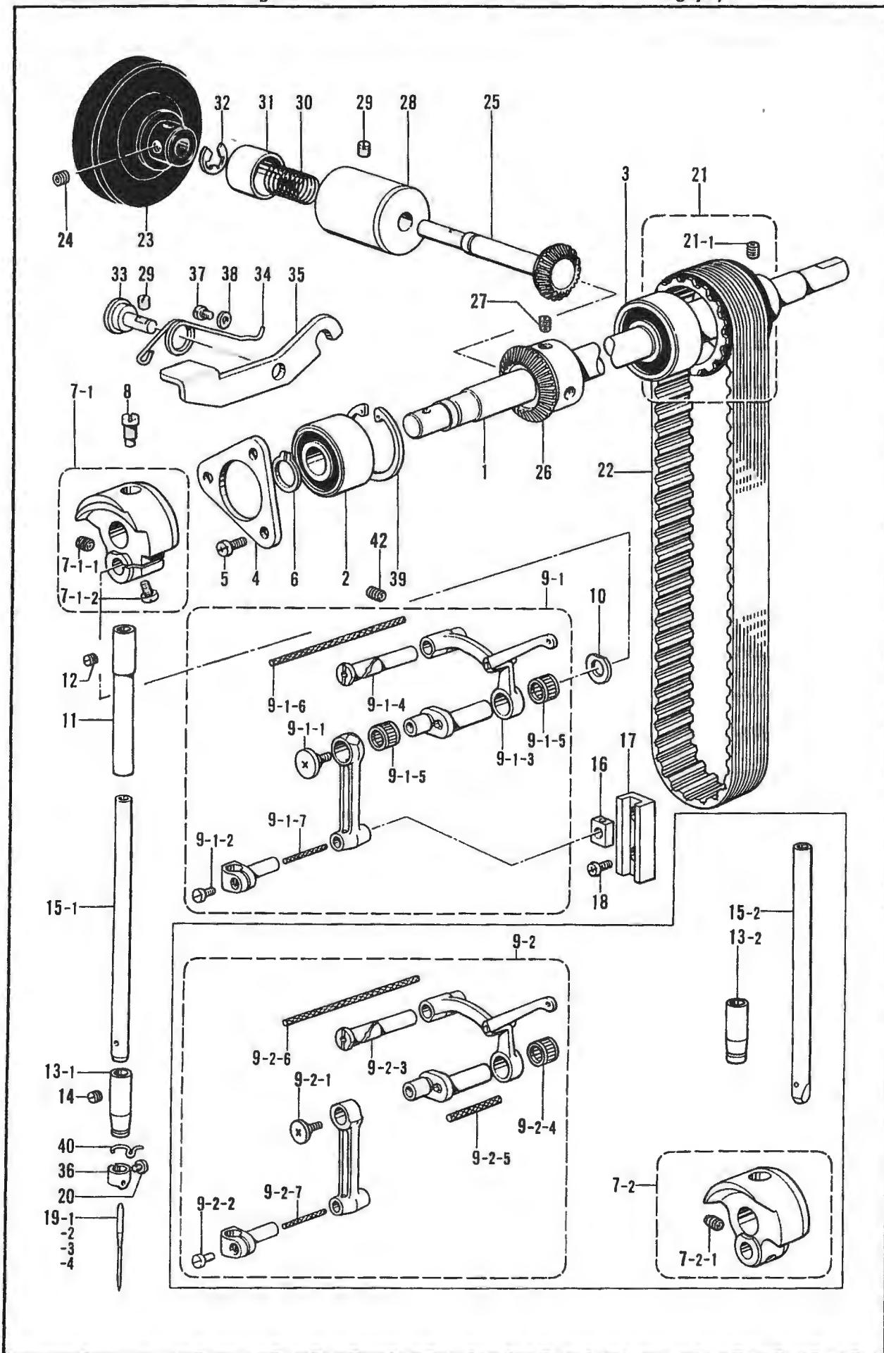
B. 針棒・天ビン関係 / Needle bar and thread take-up mechanism / Nadelstange und Fadenabnamevorrichtung /
