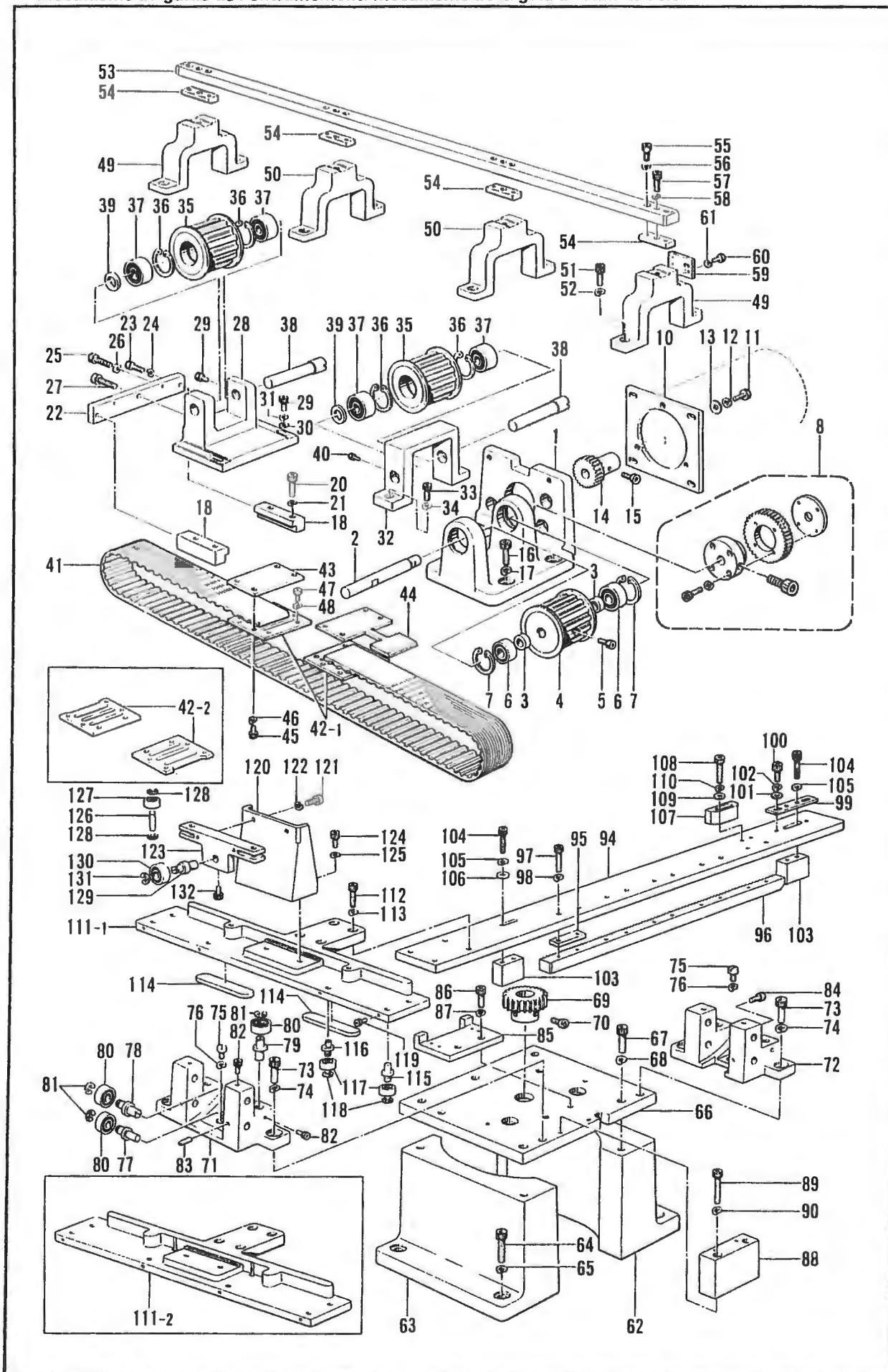
ト. 駆動側・送り関係 / Feed guide mechanism / Transportführung /
