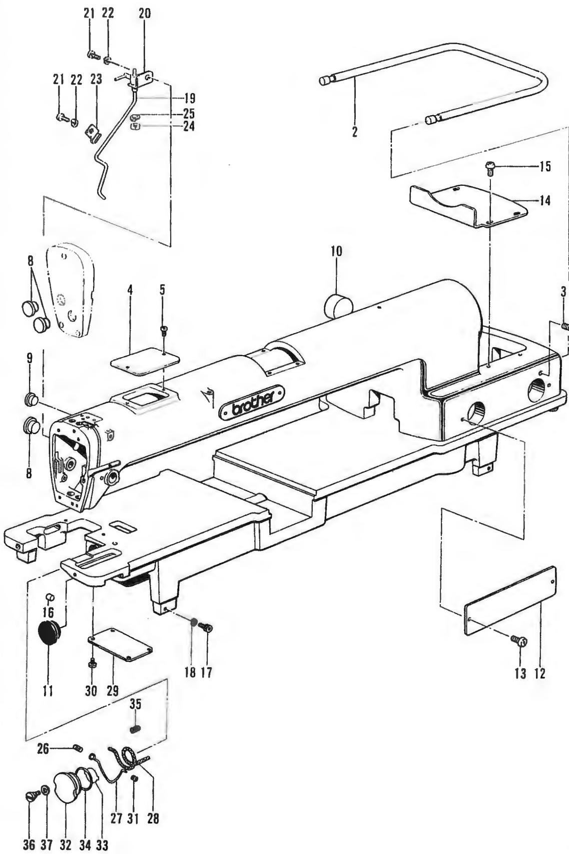
A. 王体関係 / Machine body / Maschinengehäuse /
