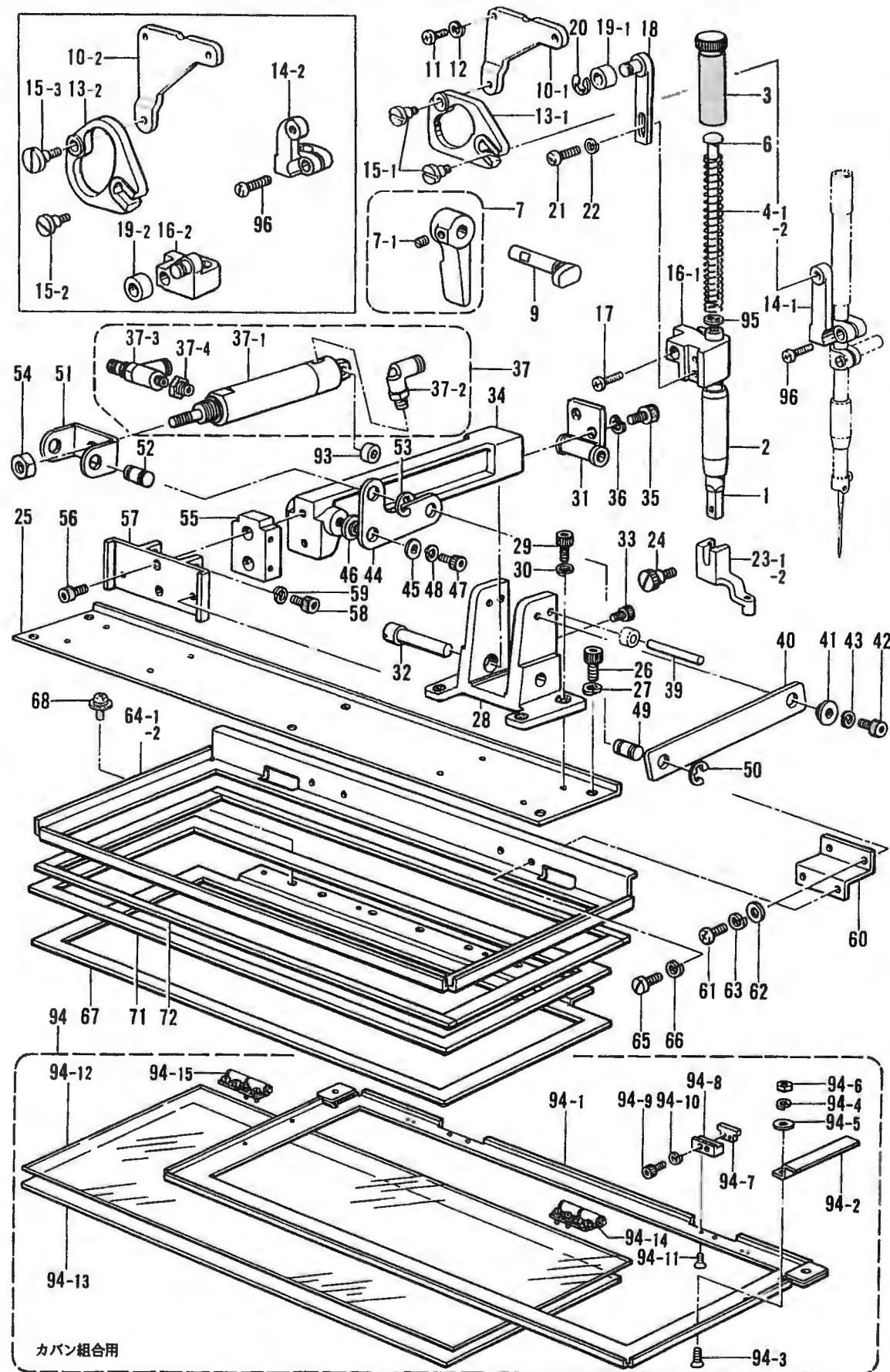
D. 押工関係/Presser foot mechanism/Stoffdrückerfuß/
