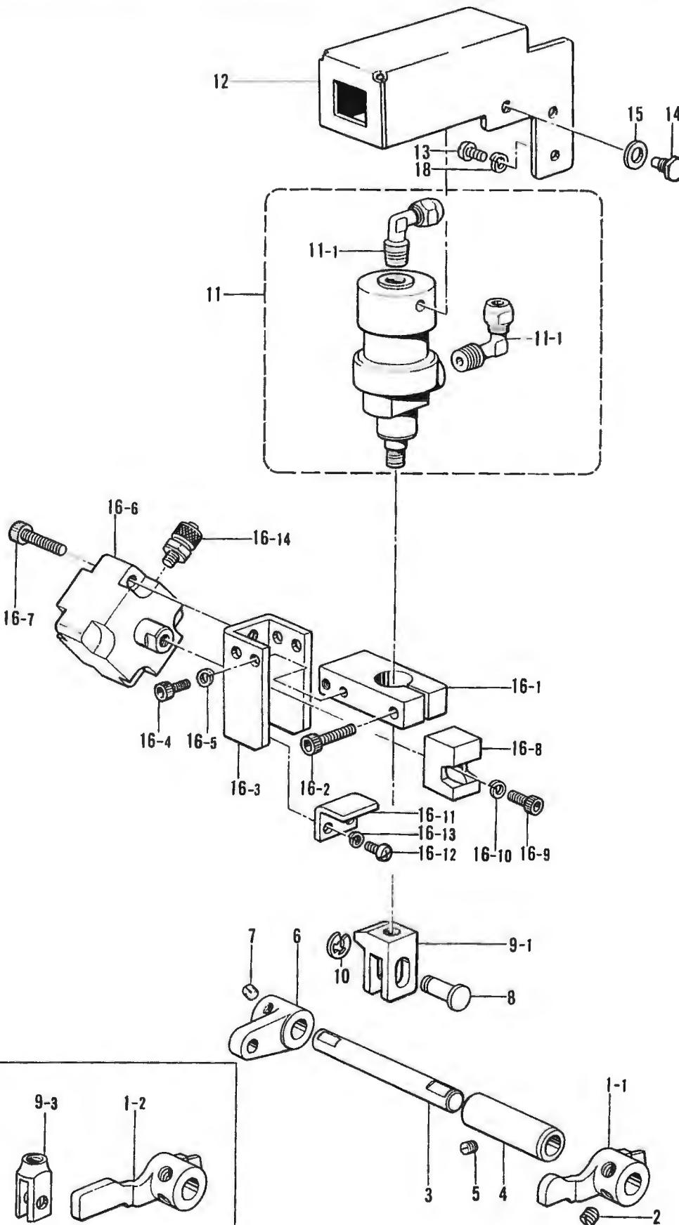
E. 押工上部関係 / Work clamp lifter mechanism / Stoffhalterhebevorrichtung /
