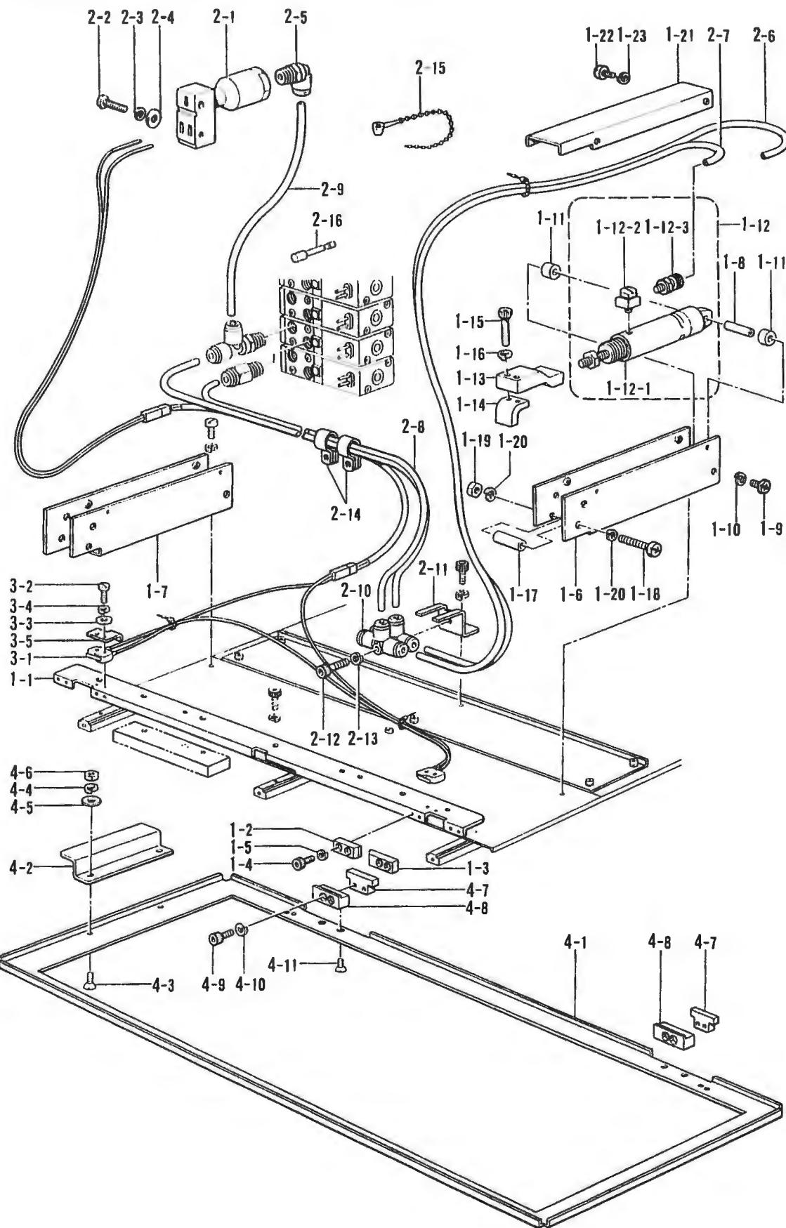
H. オートイジェクト関係/Auto eject mechanism/Automatische Auswurfvorrichtung/
