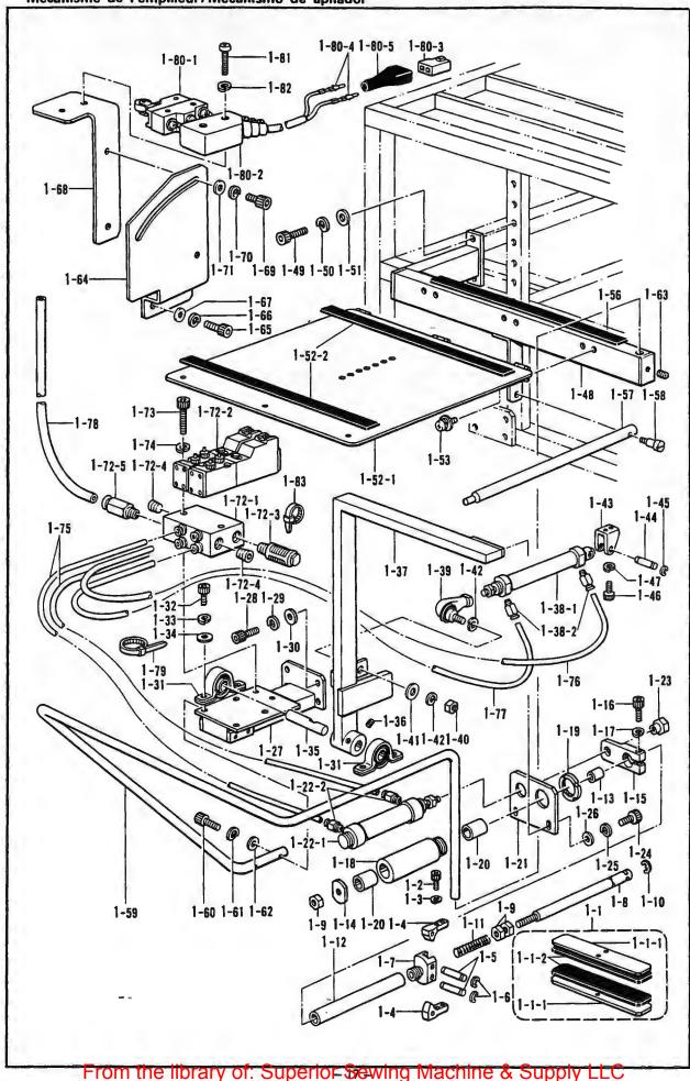
K. スタッカー関係/Stacker mechanism/Anhäufung/ Mécanisme de l'emplileur/Mecanismo de apilador
