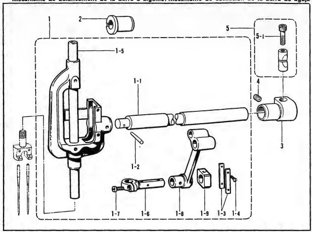
D. 下軸関係/Lower shaft mechanism/Untere welle/ Mécanisme de l'arbre inférieur/Mecanismo del eje inferior
