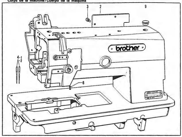
B. 上帧関係/Upper shaft mechanism/Obere welle/ Mécanisme de l'arbre superieur/Mecanismo de la eje superior
