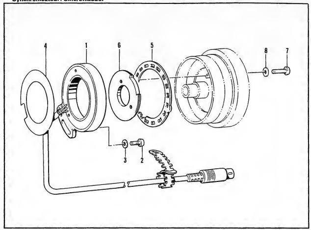
T. ゲージ部品関係/Gauge mechanism/Lehrenvorrichtung/ Mécanisme de jauge/Mecanismo del galga
