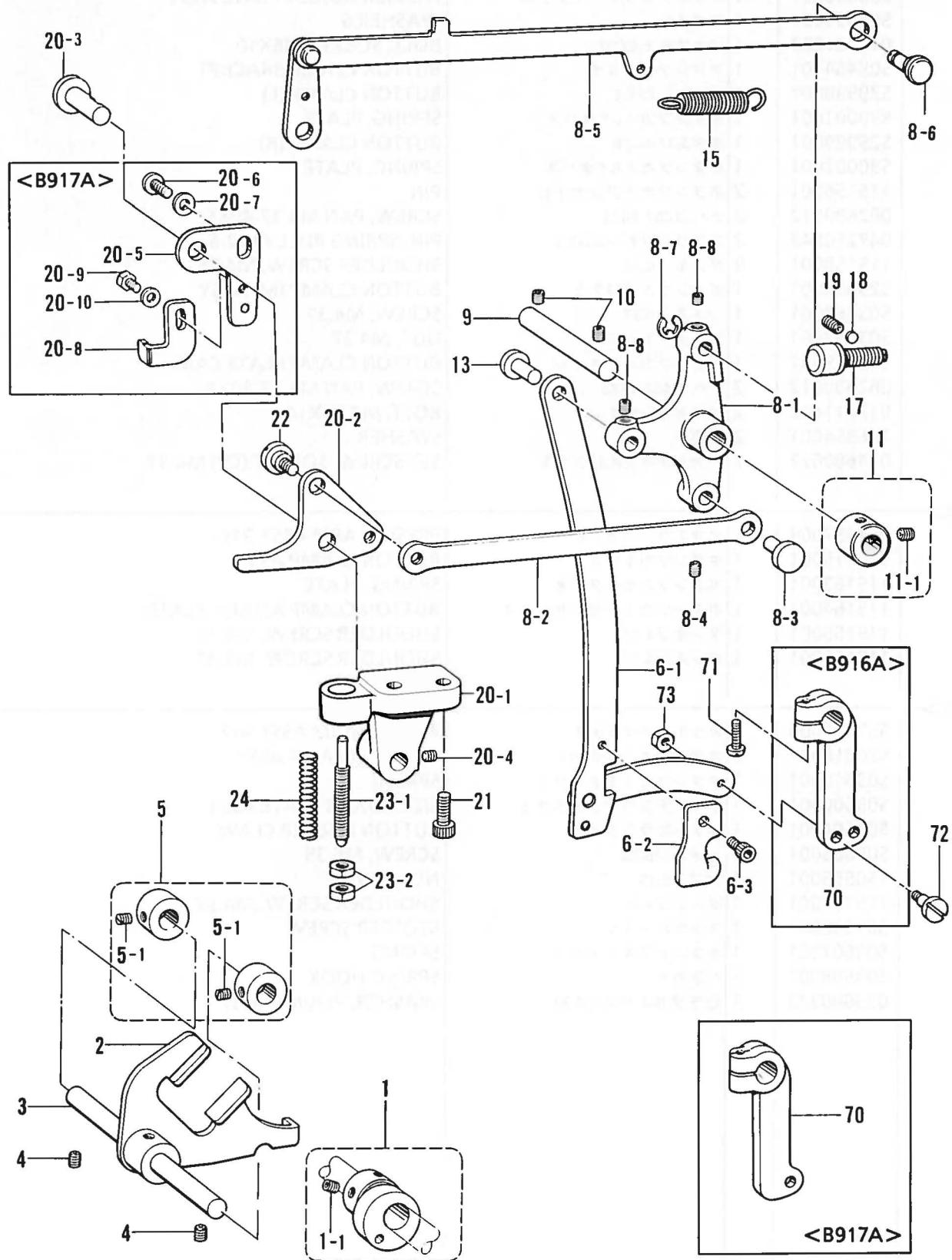
F. 押工上ヶ関係 / Presser foot lifter mechanism / Stoffhalterhebervorrichtung /
