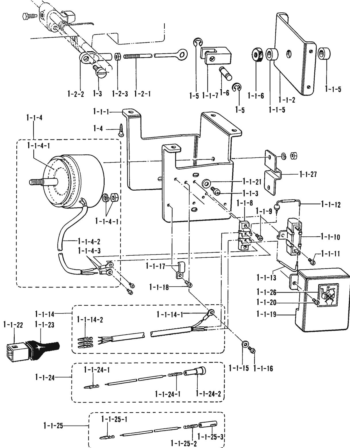
X1. 電磁押エ上ゲセット / Presser foot lifting solenoid set/Solenoidsatz für die Anhebung des Stoffdrückerfußes/
