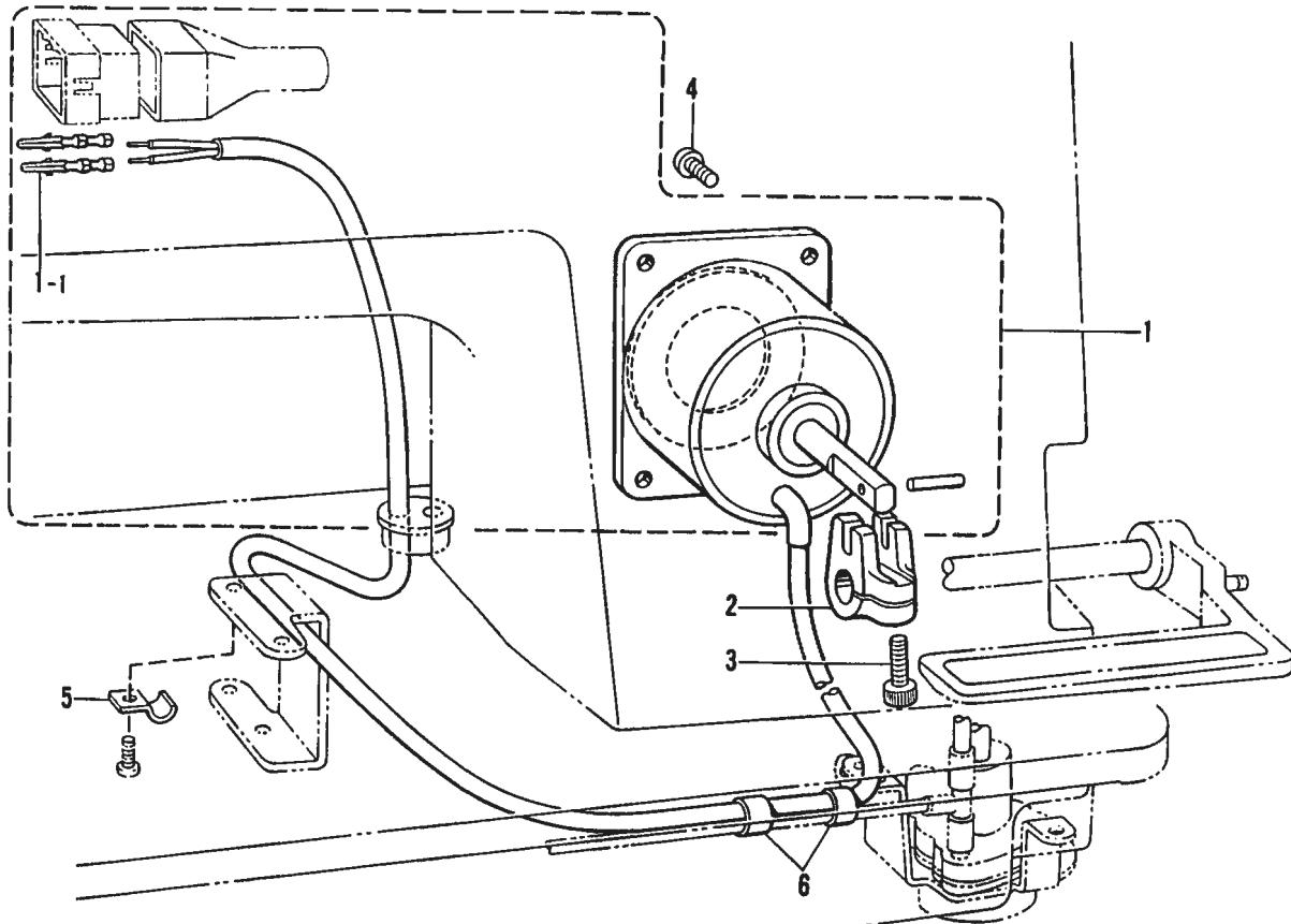
M. 糸ユルメ関係/Tension release mechanism/Spannungsverminderungsvorrichtung/
