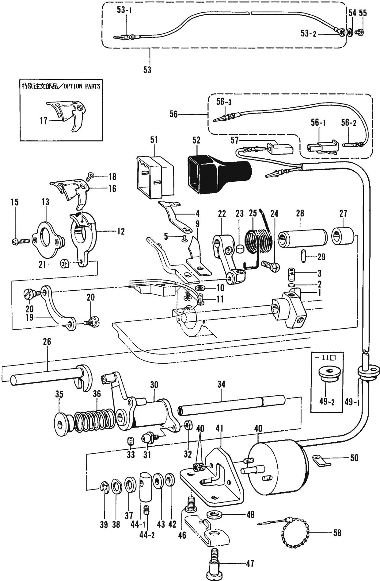
K. 糸切り関係/Thread trimmer mechanism/Fadenabschneidevorrichtung/
