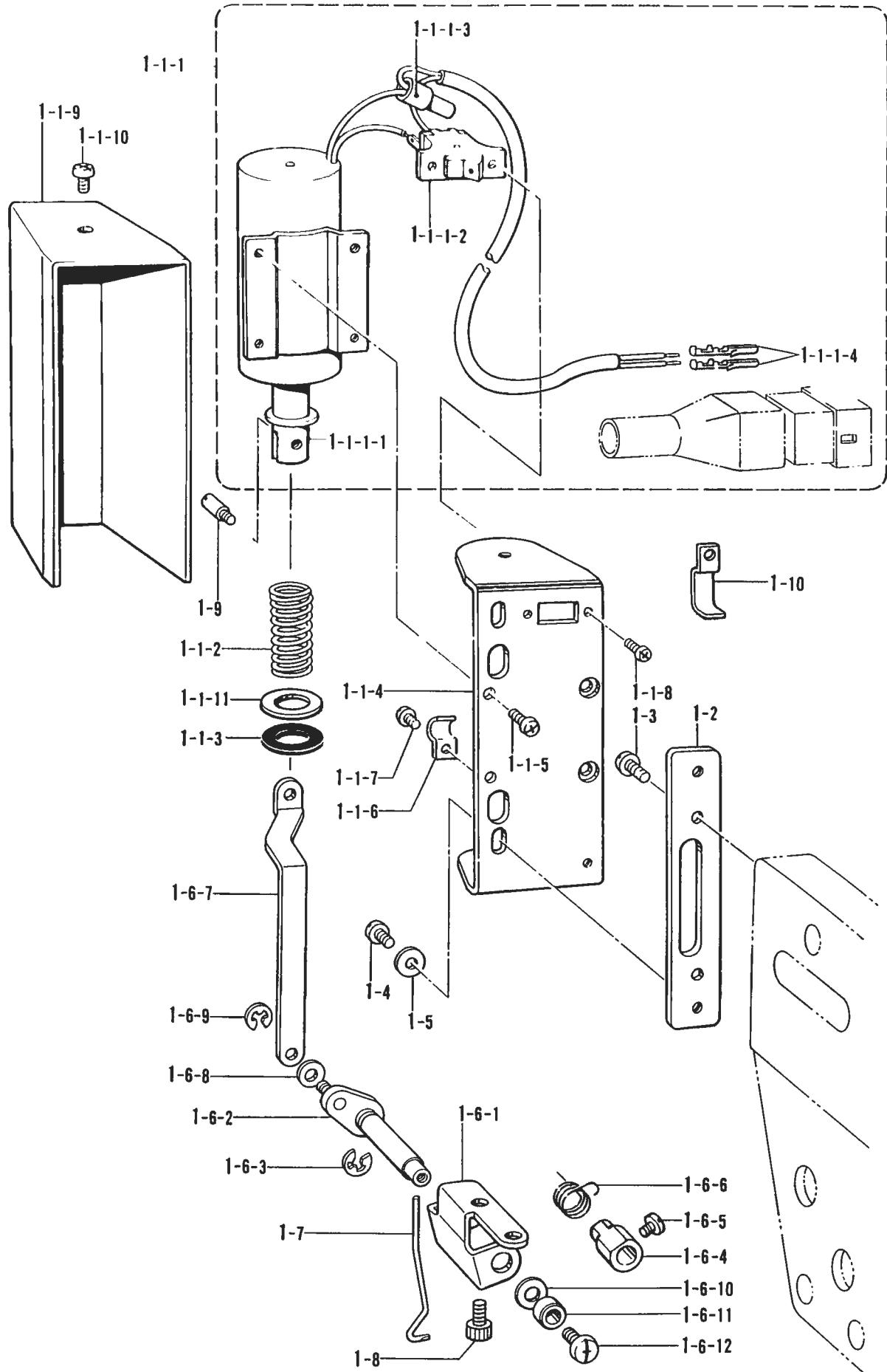
W. 糸扱イセット / Thread wiper set / Fedenspannvorrichtung /
