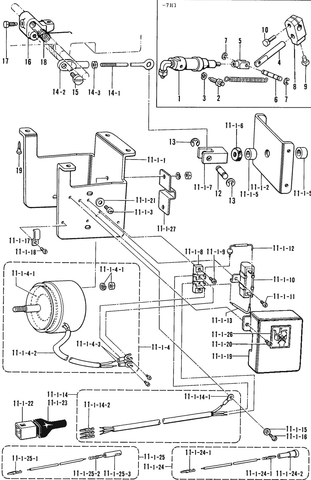
F1. 押工上ヶ関係 / Work clamp lifter mechanism / Stoffhalterhebervorrichtung /
