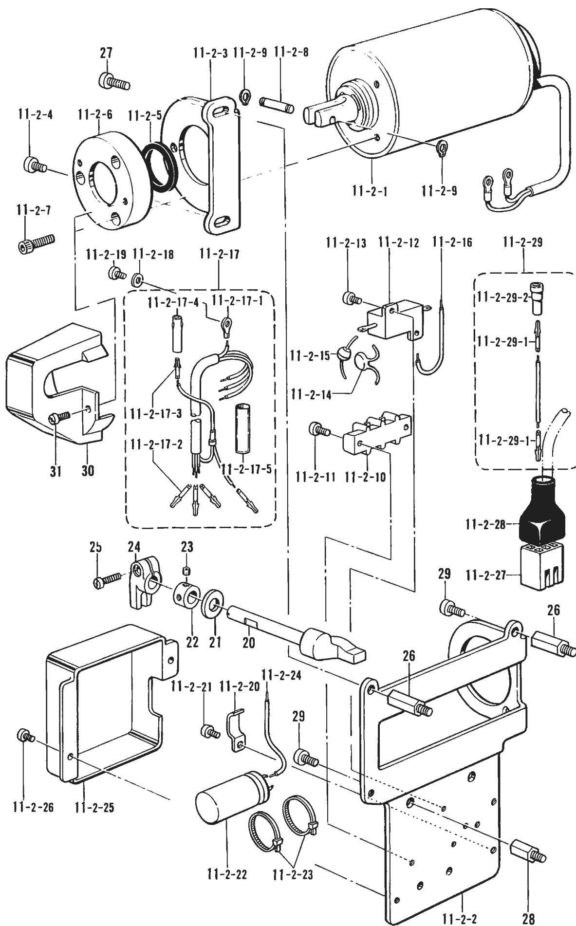
F2. 押工上げ関係 /Work clamp lifter mechanism/Stoffhalterhebervorrichtung/
