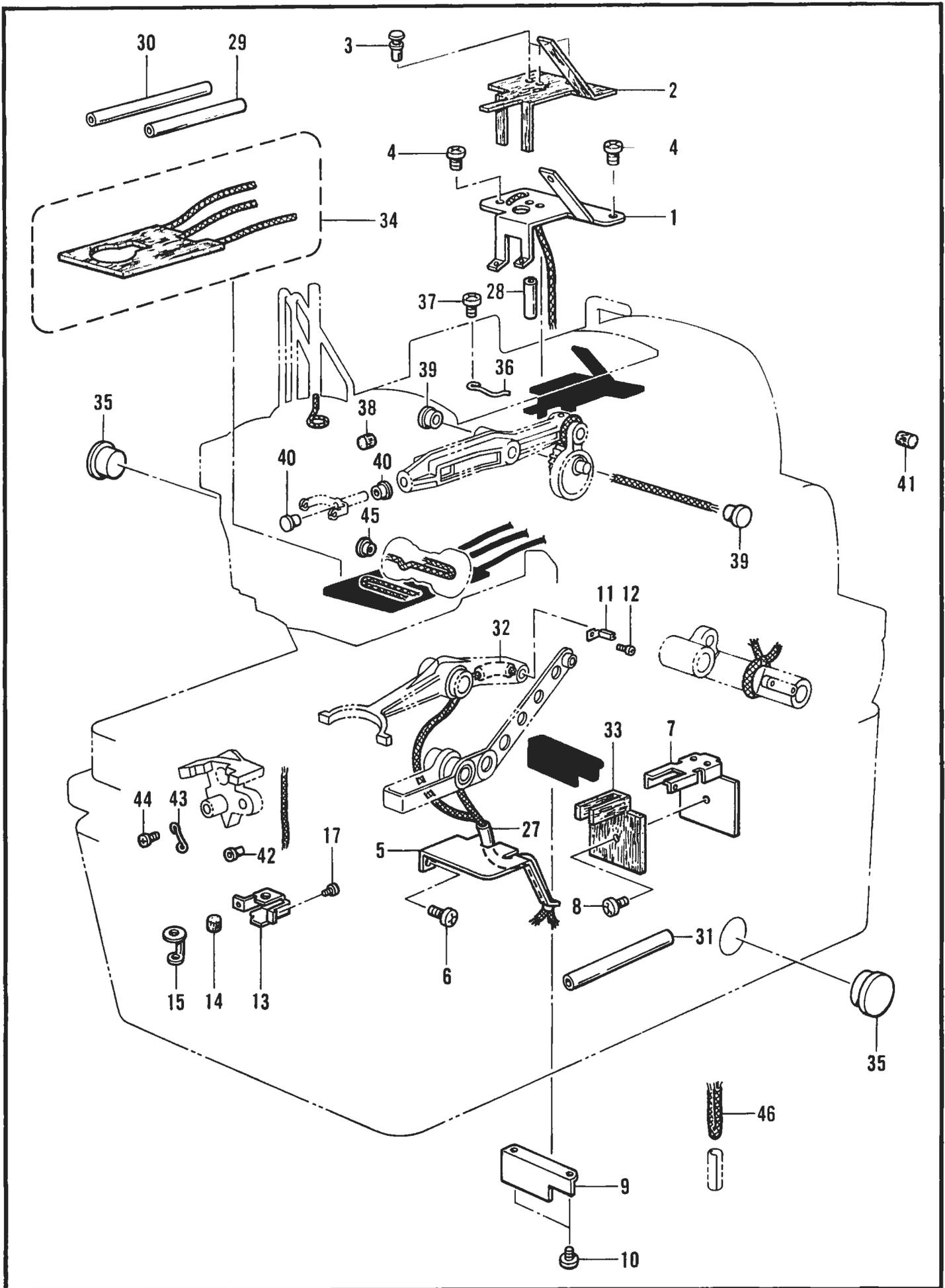
P. 給油潤滑関係 / Lubrication / Schmierung / Lubrification / Lubricación
