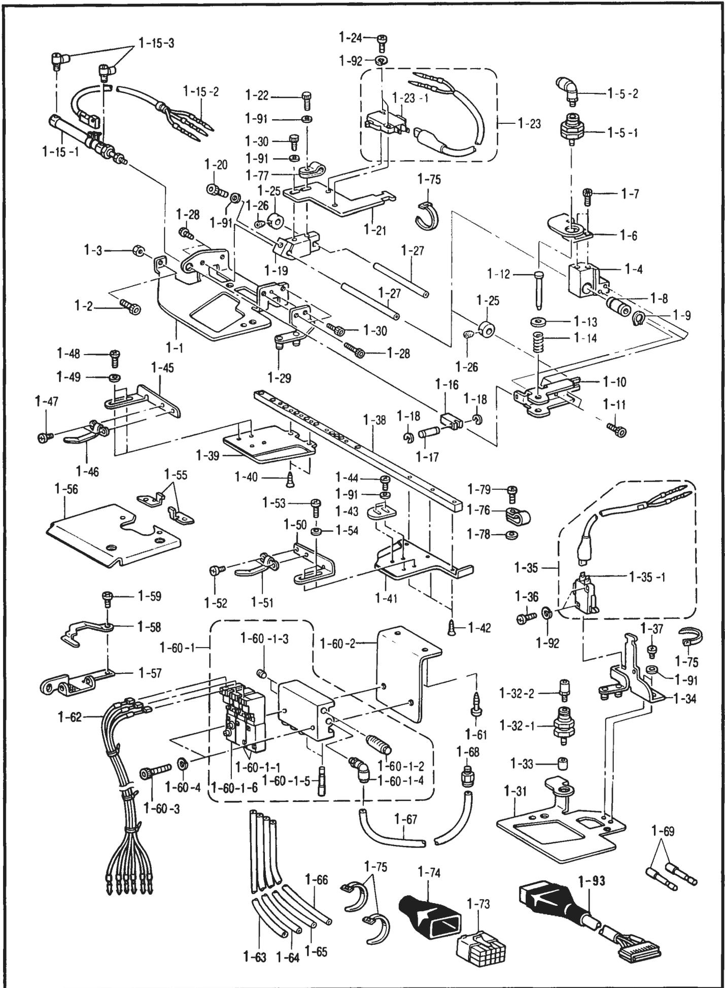
Y. 布制御関係 / Cloth control system mechanism / Stoffführungsrichtung / Mécanisme de la système de contrôle du tissu / Mecanismo de la sistema de control de tela
