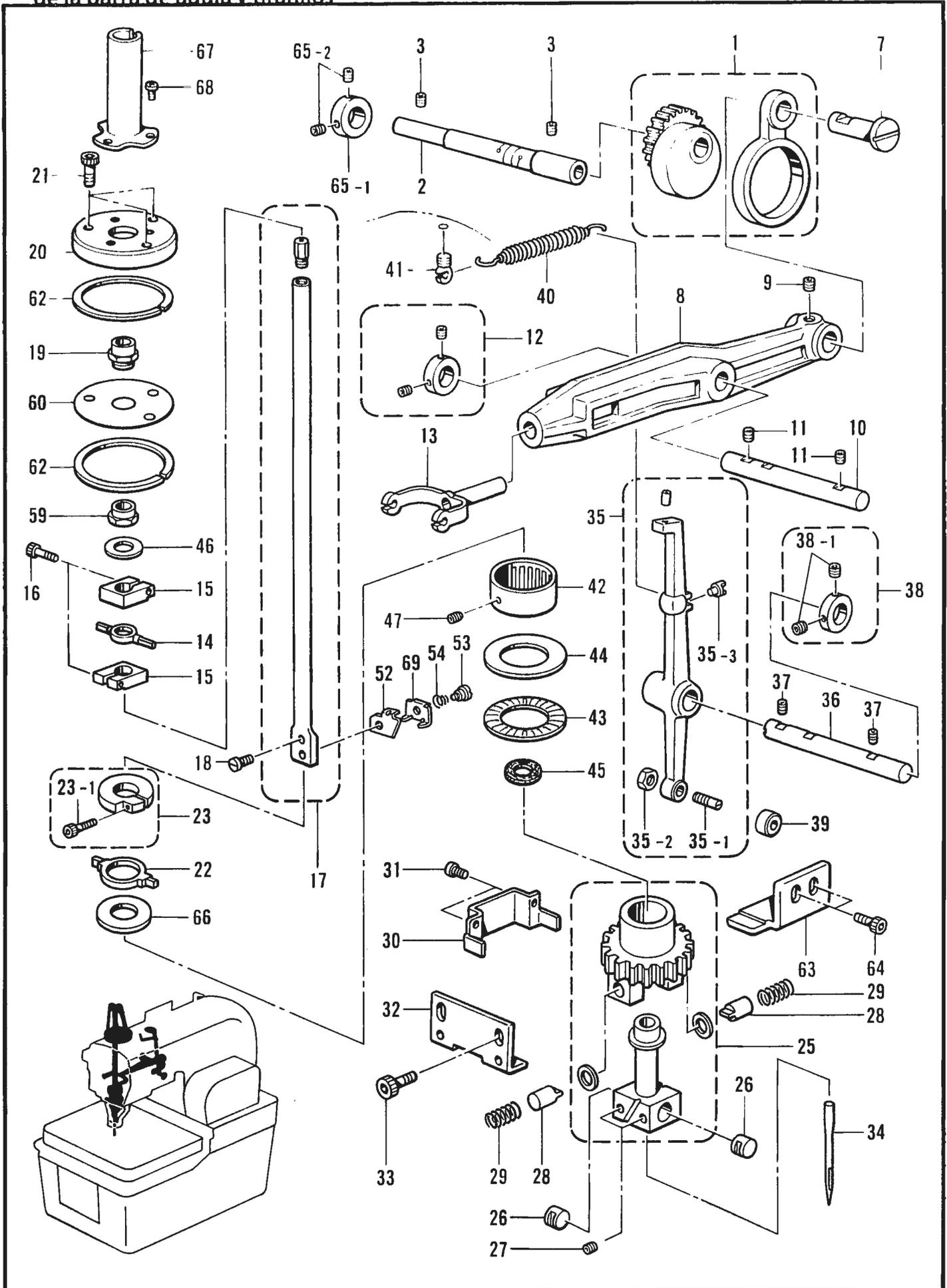
B. 針棒・天秤関係 / Needle bar and thread take-up mechanism / Nadelstange und Fadenabnahmevorrichtung / Mécanisme de la barre à aiguille et releveur de fil / Mecanismo de la barra de aguja y tirabilos
