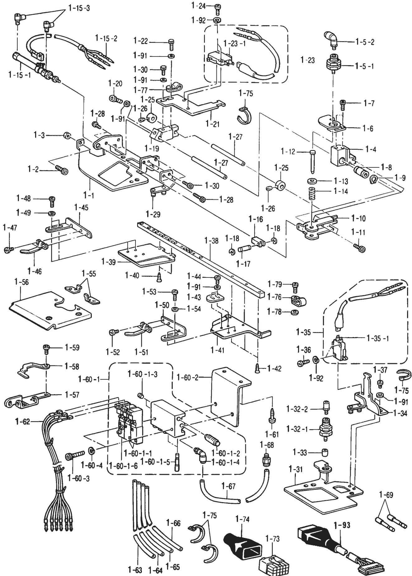
Y. 布制御関係 / Cloth control system mechanism / Stoffführungsvorrichtung / Mécanisme de la système de contrôle du tissu / Mecanismo de la sistema de control de tela
