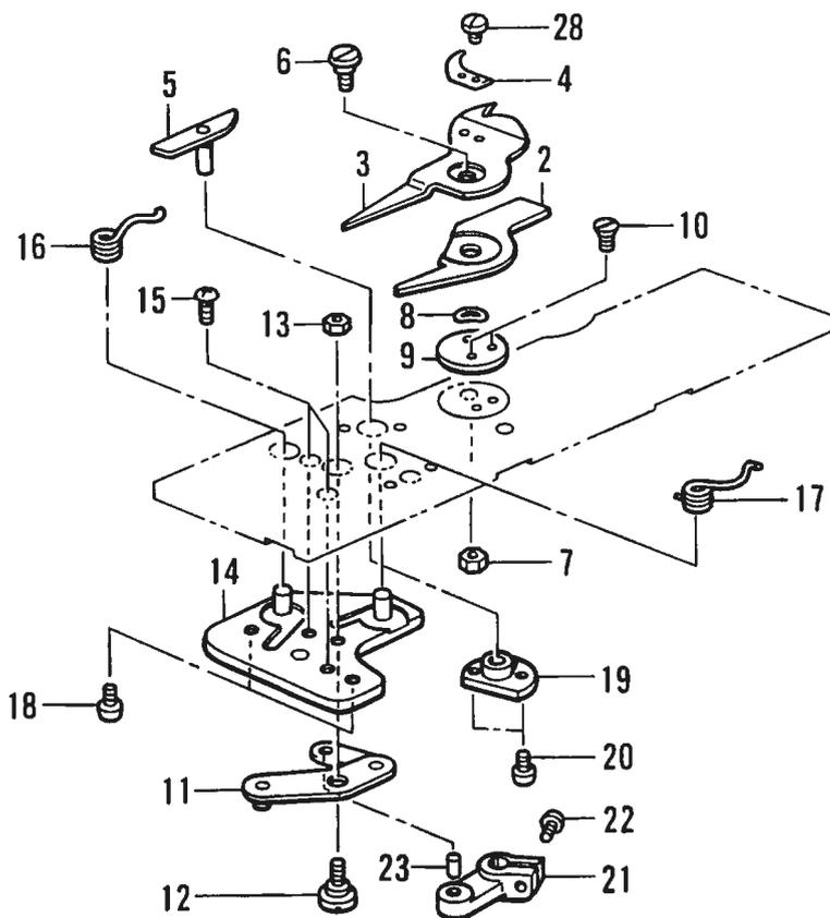
R. 糸切り関係 / Thread trimmer mechanism / Fadenabschneidevorrichtung /
