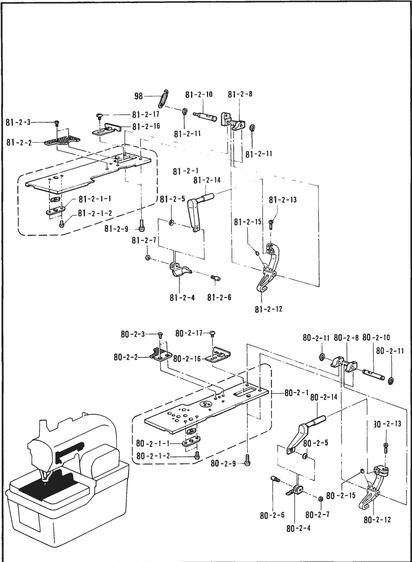
F. 押工関係 / Presser foot mechanism / Stoffdrückerfuß / Mécanisme de pied presseur / Mecanismo de la prensa tela
