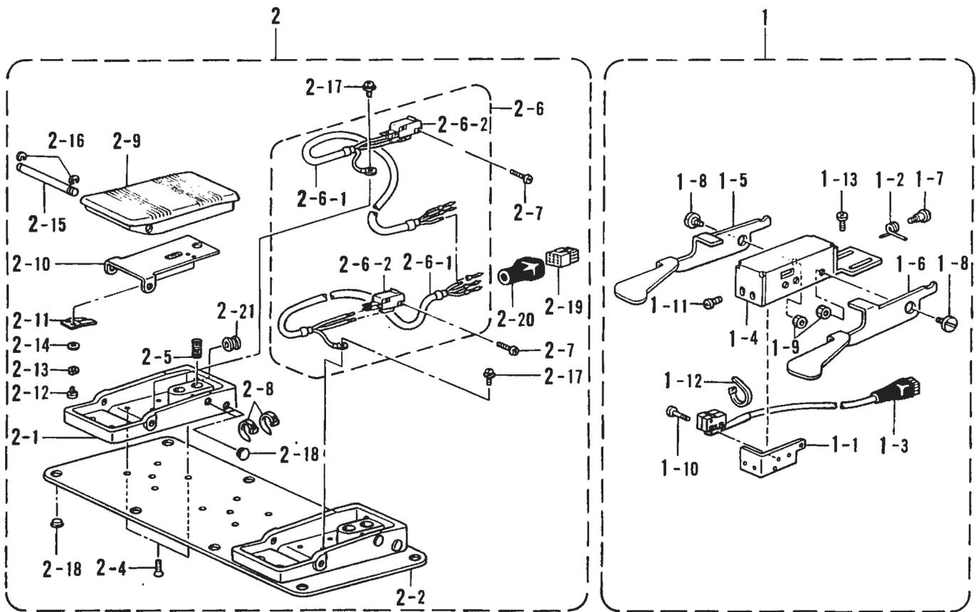
X. 踏板関係 / Foot switch pedal mechanism / Fußbetätigung / Mécanisme de la pédale / Mecanismo del pedal
