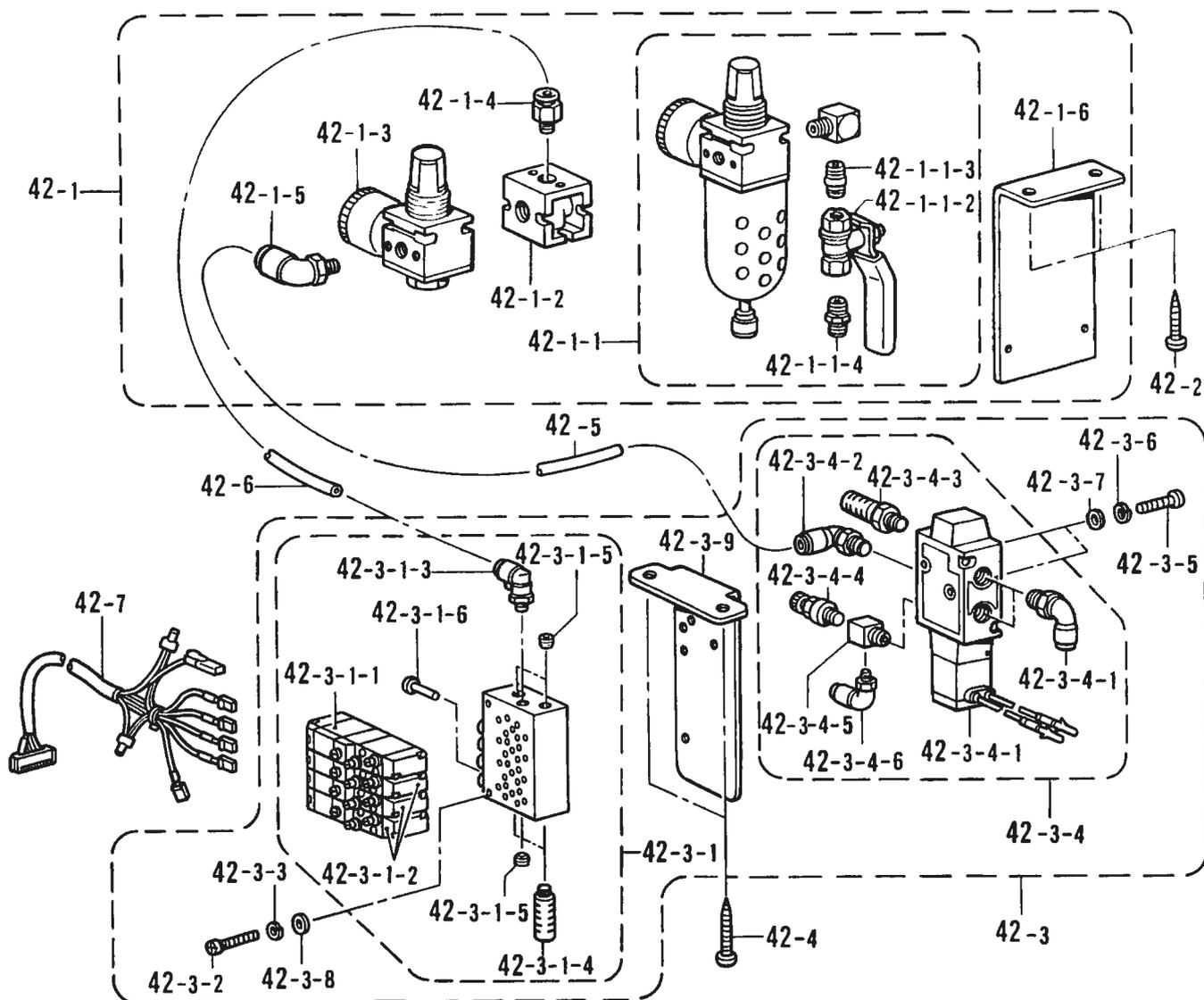
V. 空圧関係 / Air pressure mechanism / Luftdruck / Mécanisme de la pression d'air / Mecanismo de la presión de aire
