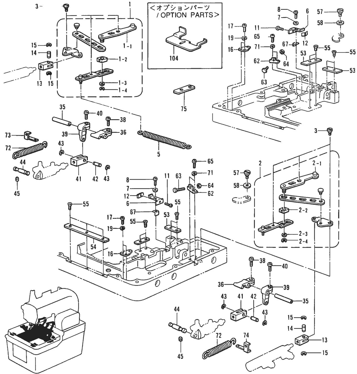
F. 押工関係 / Presser foot mechanism / Stoffdrückerfuß / Mécanisme de pied presseur / Mecanismo de la prensa tela
