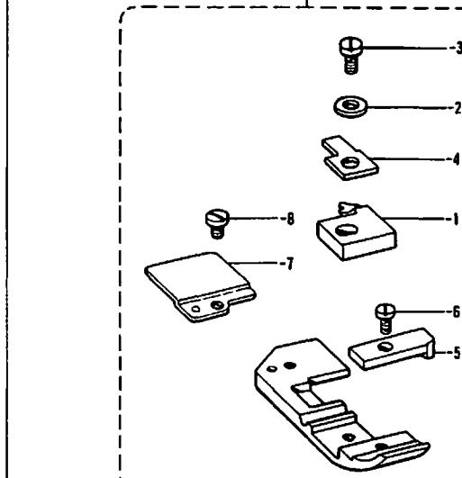
E. 押工関係/Presser foot mechanism/Stoffdrückerfuß/
