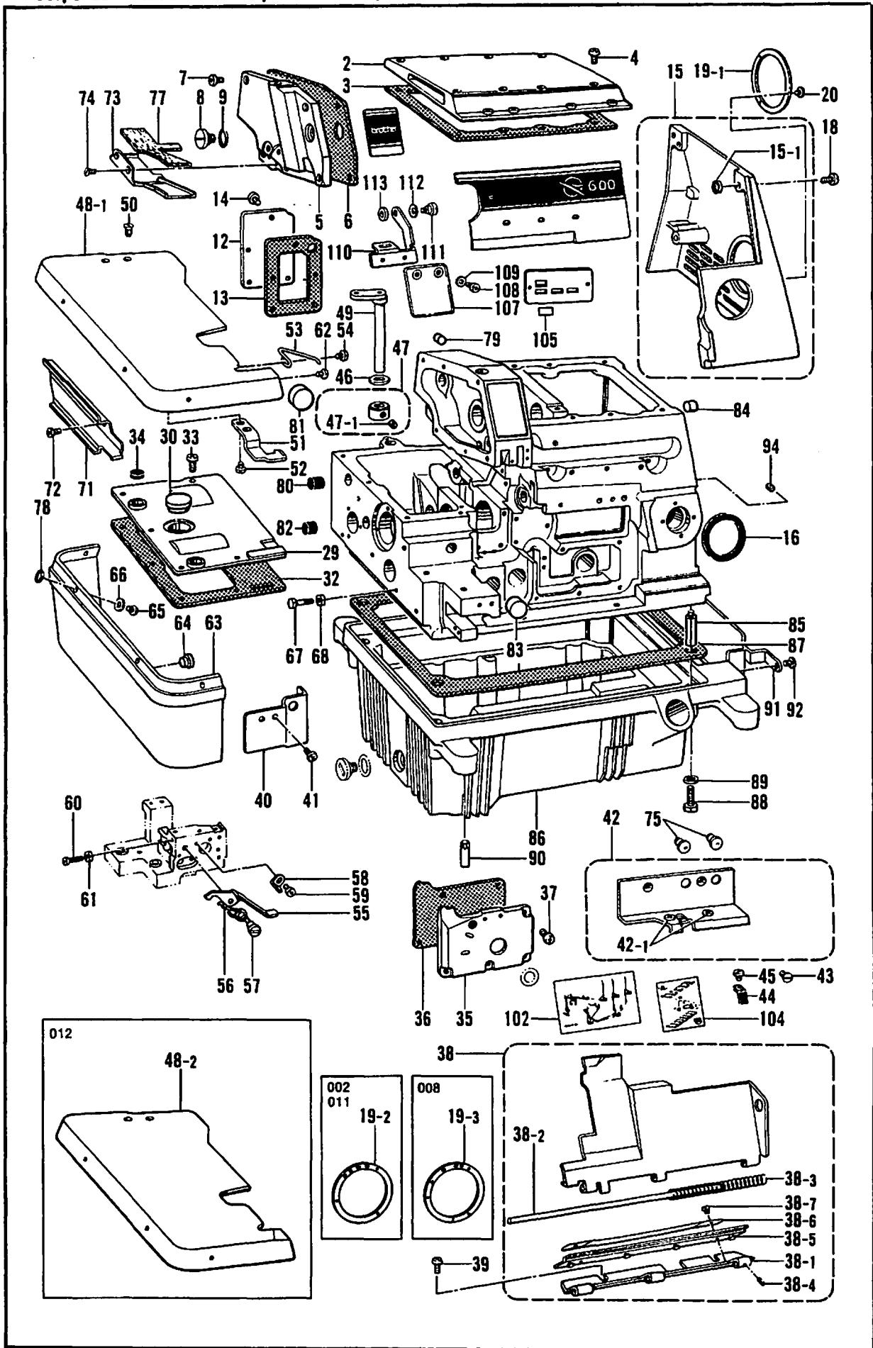
A. フレーム関係/Machine body/Maschinengehäuse/
