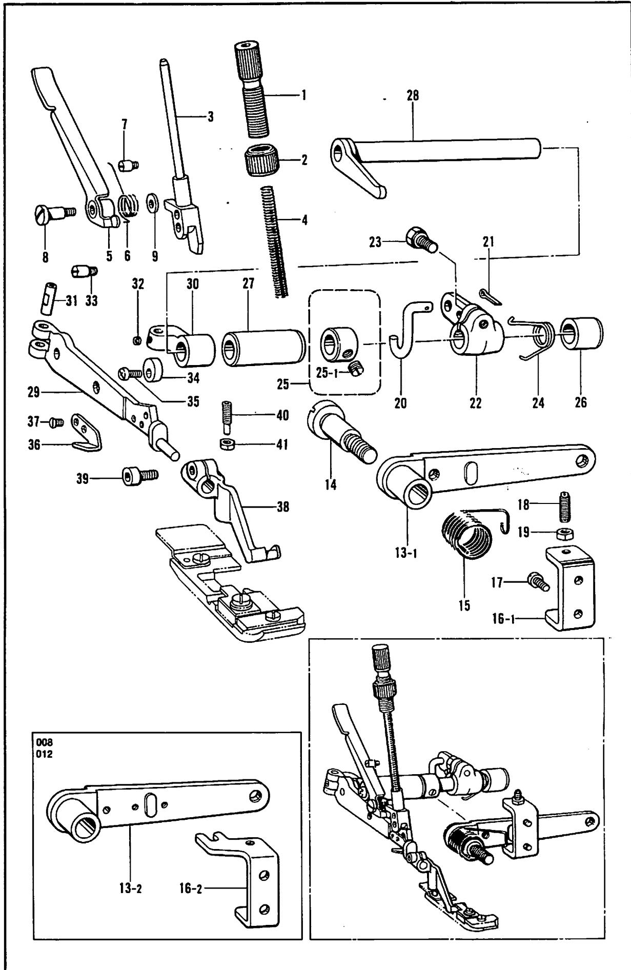
E. 押工関係/Presser foot mechanism/Stoffdrückerfuß/
