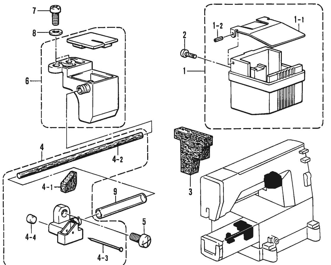
C2. 押工関係 /Presser foot mechanism/Stoffdrückerfuß/
