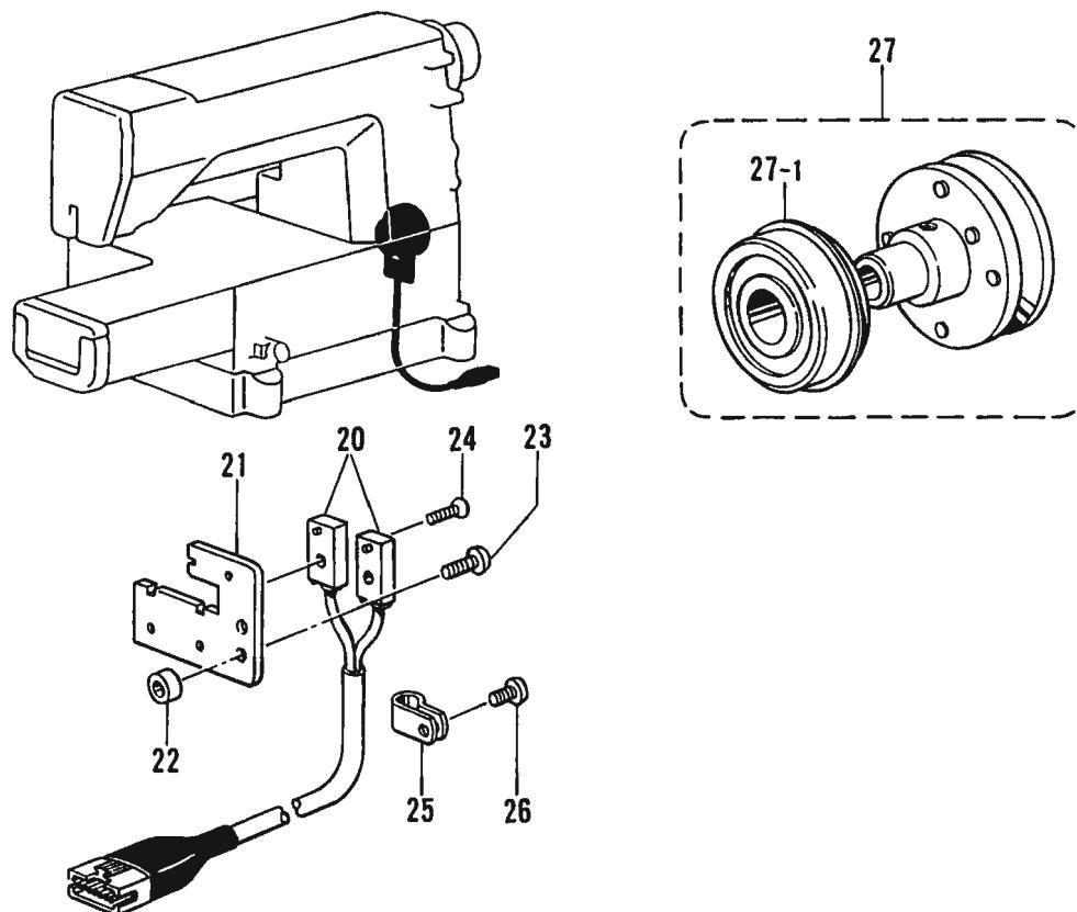
Q1. 電磁式テープカッター装置関係 / Solenoid type tape cutter mechanism / Bandabschneidesolenoid /
