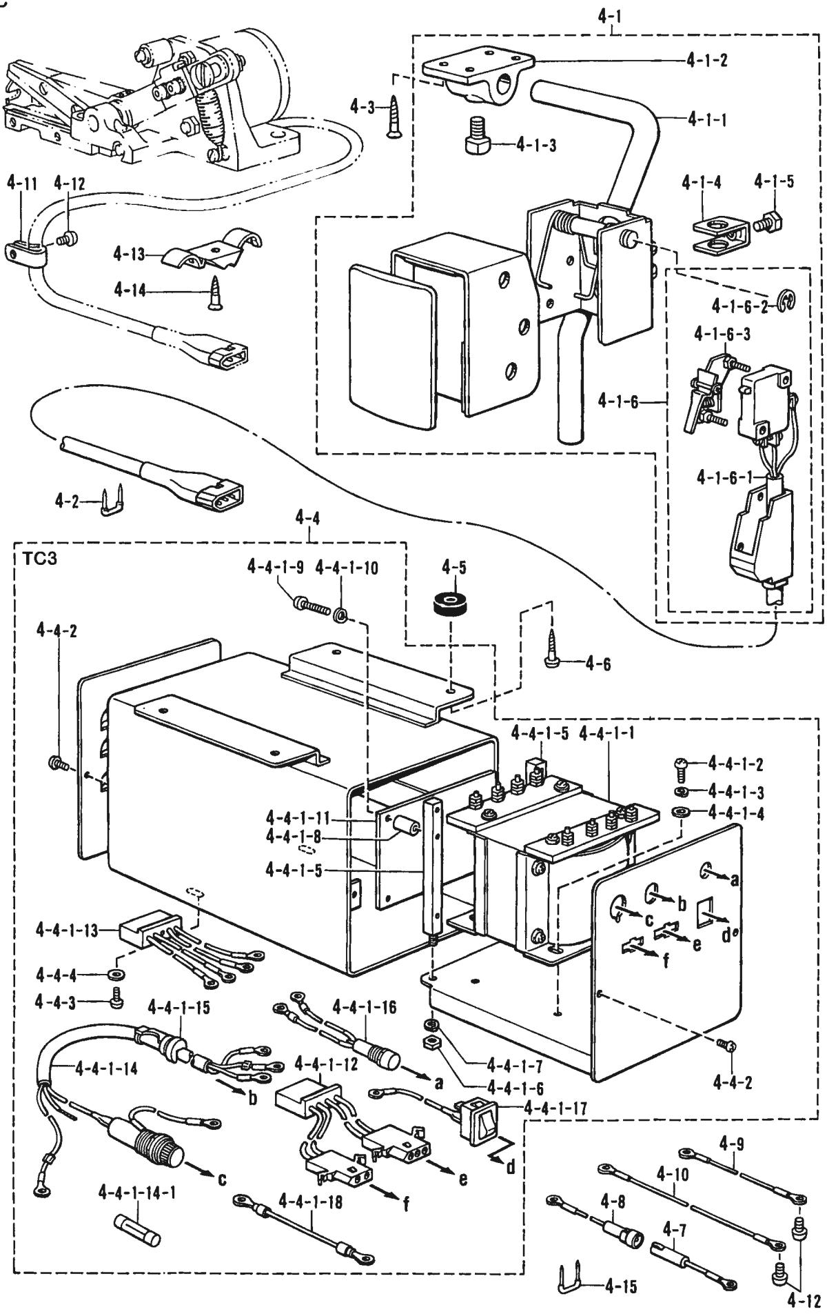
Q5. テープカッター装置関係 / Tape cutter mechanism / Bandabschneidesolenoid /
