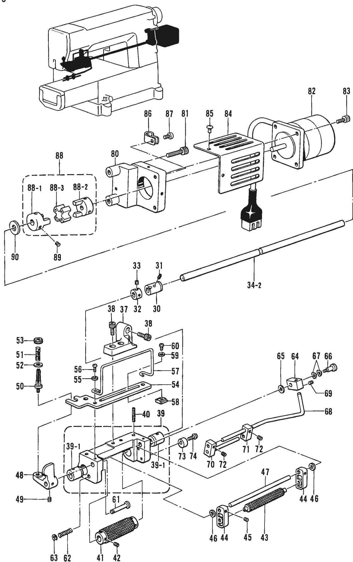
P1. パルスモータ式上ゴム送り関係 /Pulse motor drive top metering mechanism/
