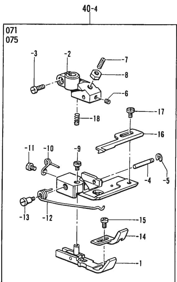
C2. 押工関係 /Presser foot mechanism/Stoffdrückerfuß/
