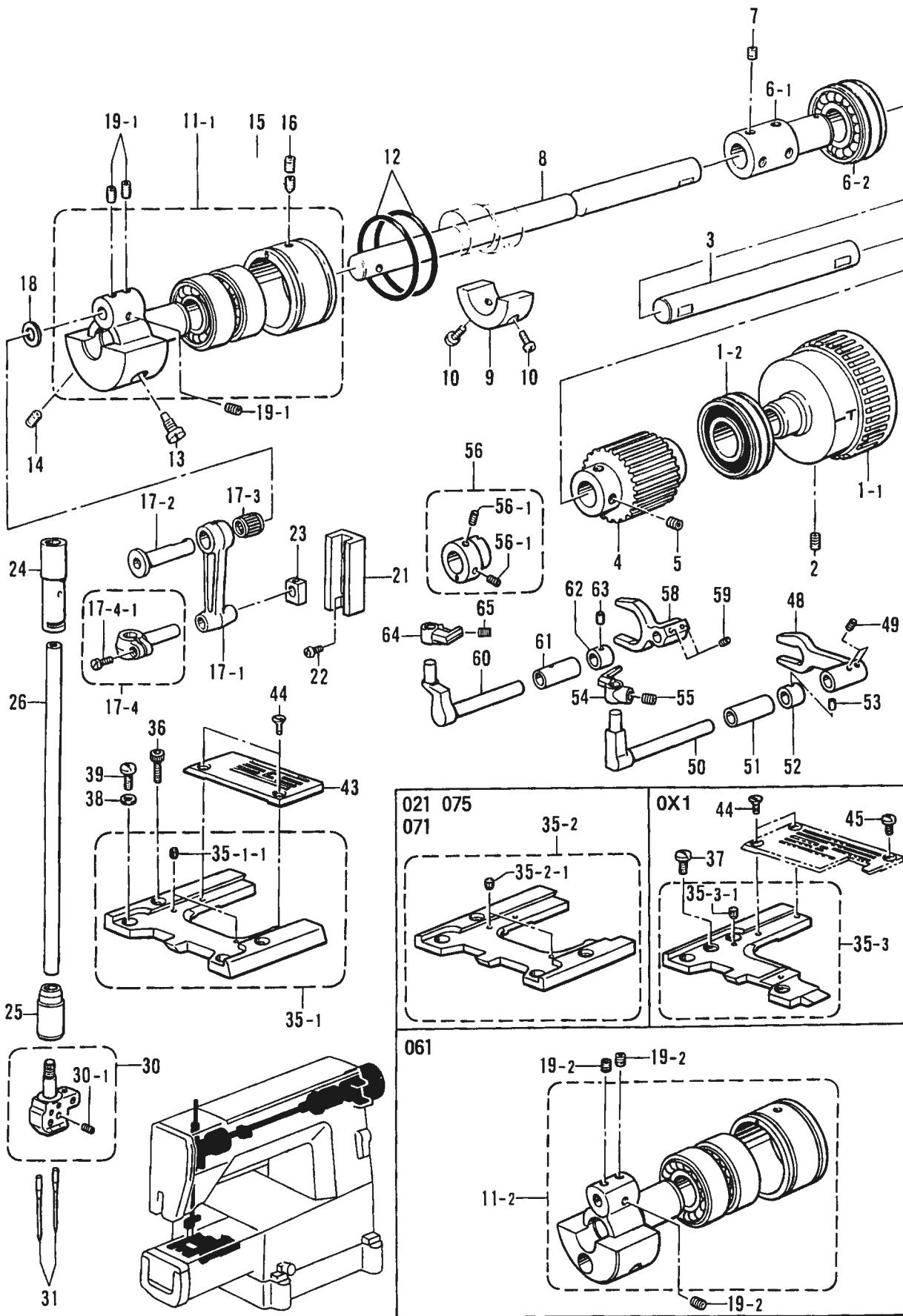
B. 上軸・針棒関係 / Upper shaft and needle bar mechanism / Obere welle und Nadelstangenvorrichtung /
