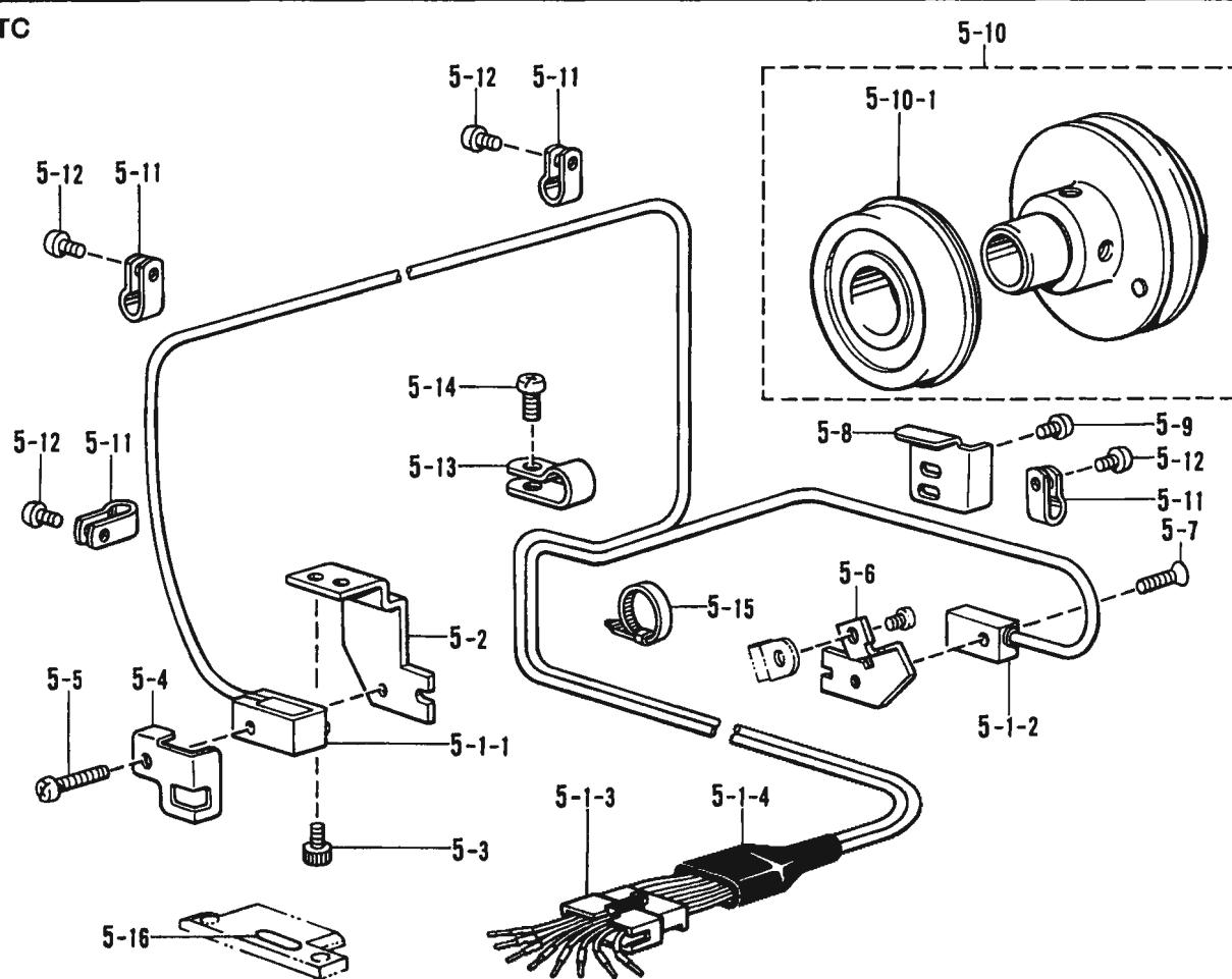
P4. パルスモータ式上ゴム送り関係 /Pulse motor drive top metering mechanism/
