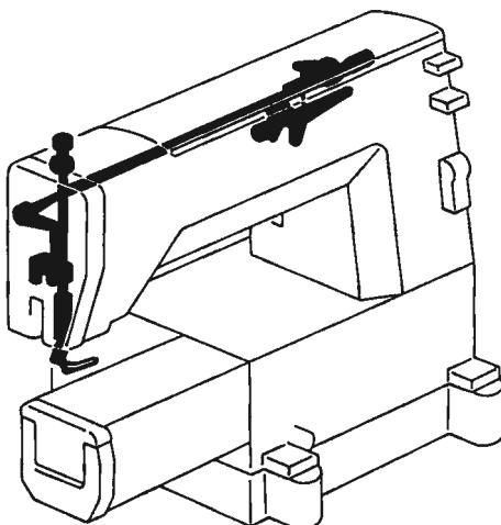
C1. 押工関係 /Presser foot mechanism/Stoffdrückerfuß/
