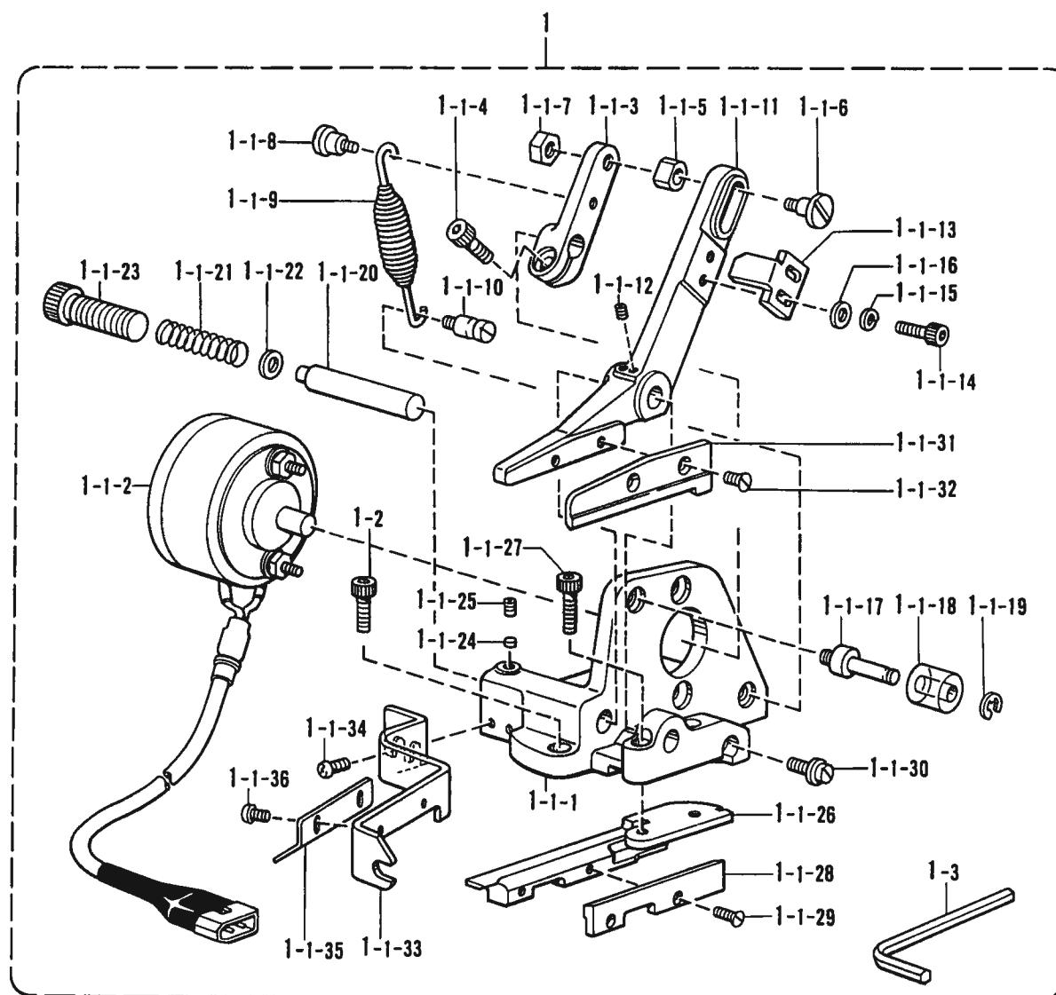
Q2. 電磁式テープカッター装置関係 /Solenoid type tape cutter mechanism/Bandabschneidesolenoid/
