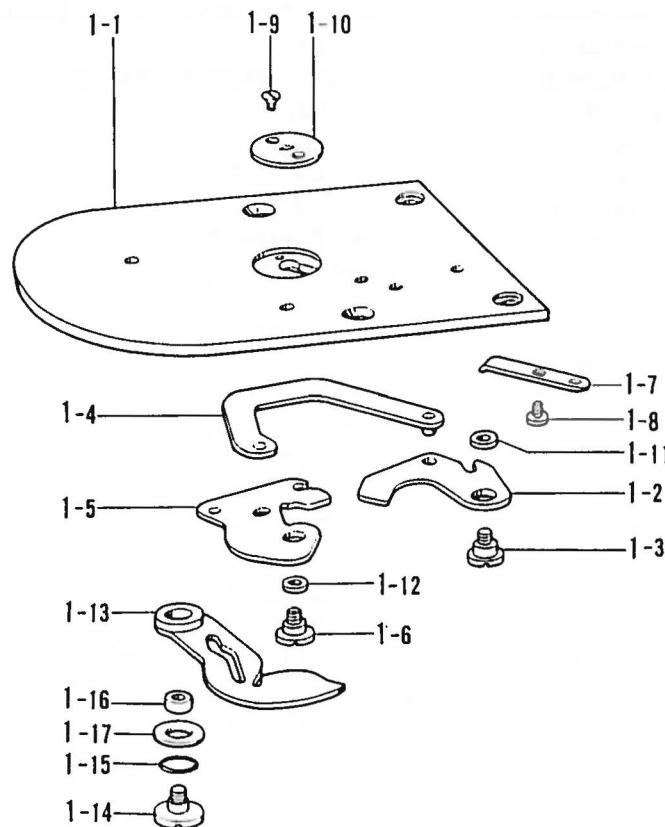
P. 動車・遊車関係 / Drive pulley and idler pulley mechanism / Antriebsriemenscheibe und Riemscheibe / Mécanisme de poulie d'entraînement et poulie folle / Mecanismo de polea impulsora y polea tensora
