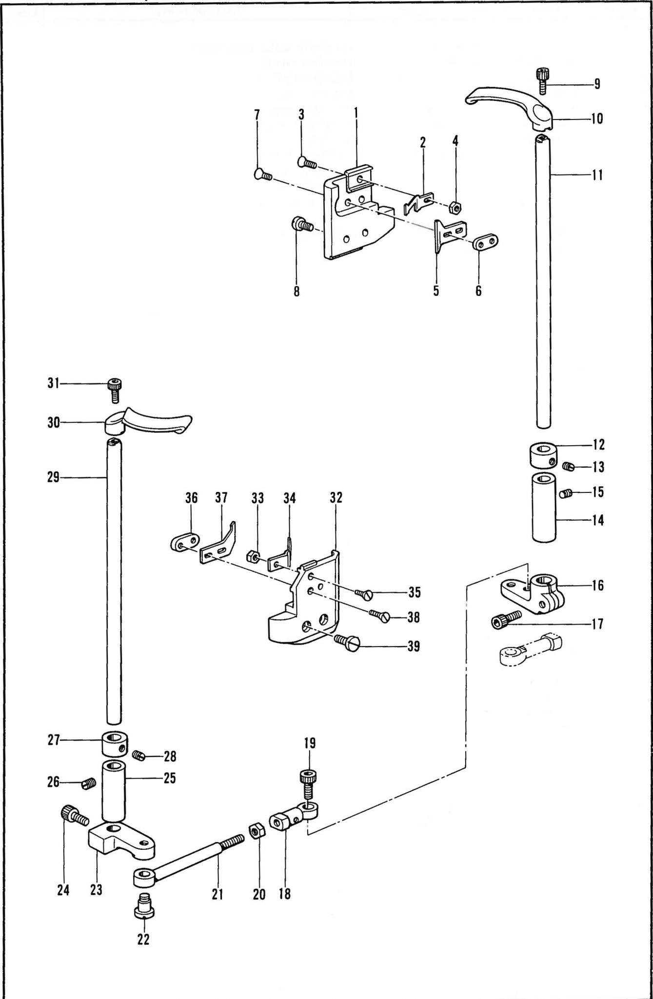
M1. 糸切り関係/Thread trimmer mechanism/Fadenabschneidevorrichtung/
