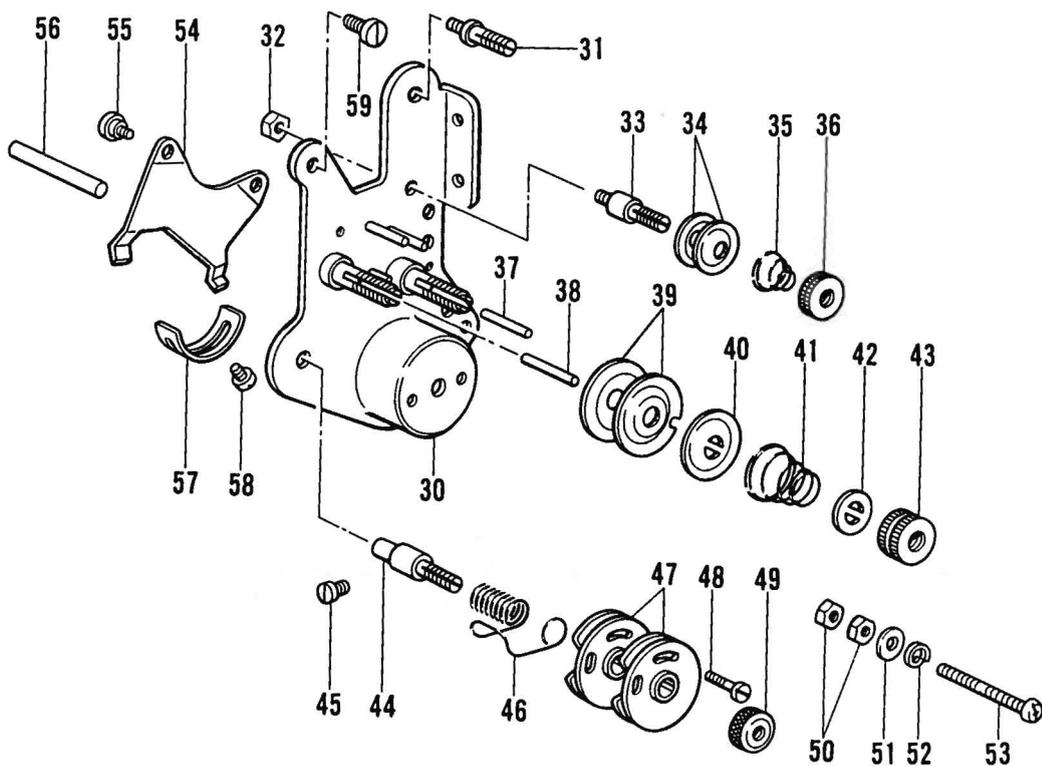
L3. 糸調子関係/Thread tension/Faderspannung/
