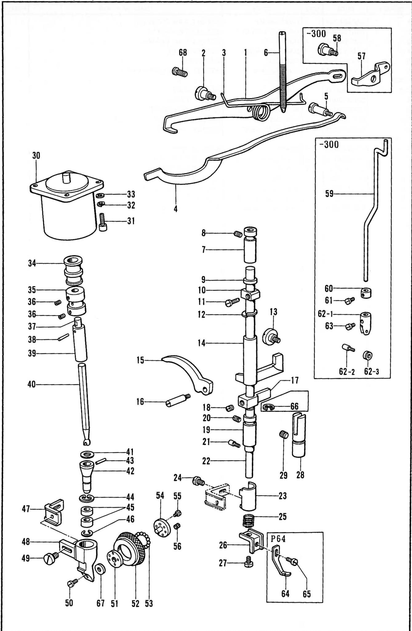
D. 押工関係/Presser foot mechanism/Stoffdrückerfuß/
