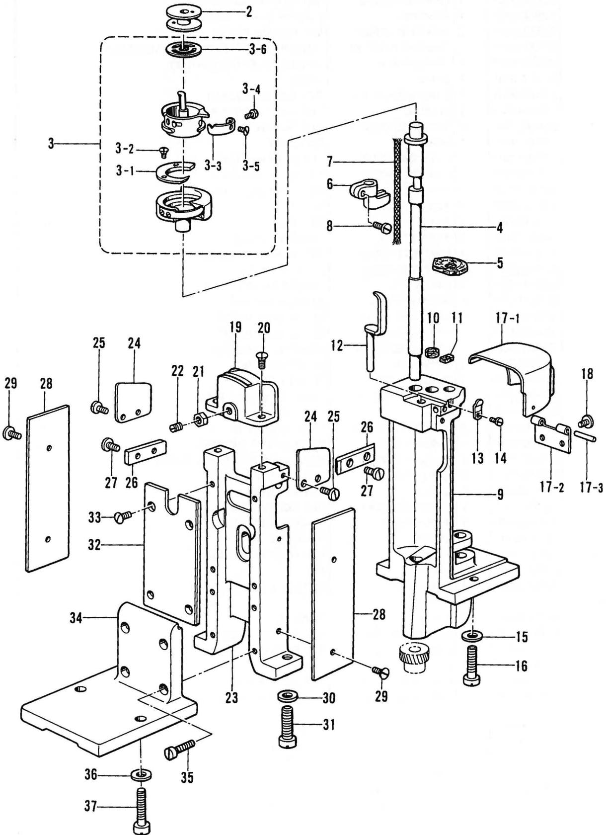
J1. カマ関係/Rotary hook mechanism/Greifervorrichtung/
