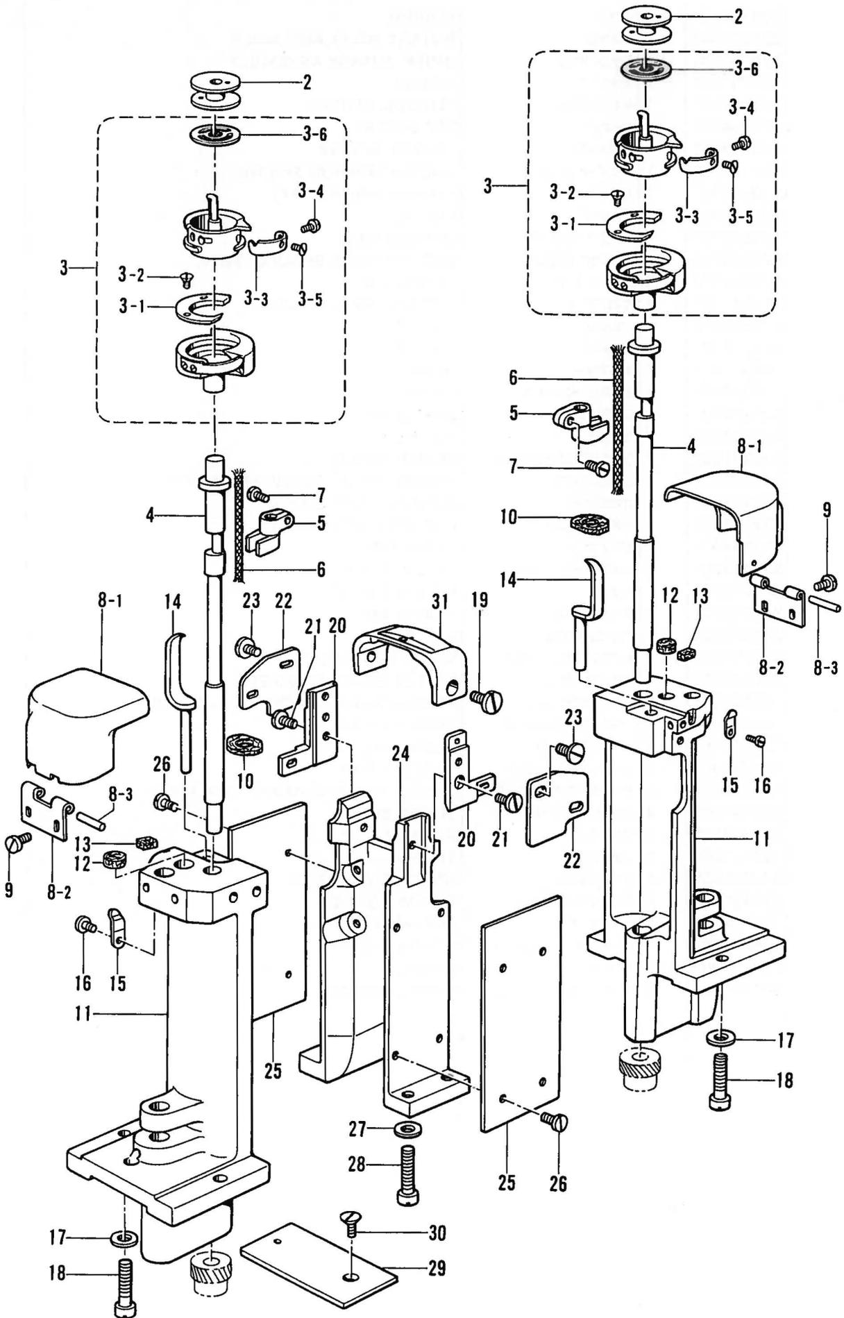
J2. カマ関係 / Rotary hook mechanism / Greifervorrichtung /
