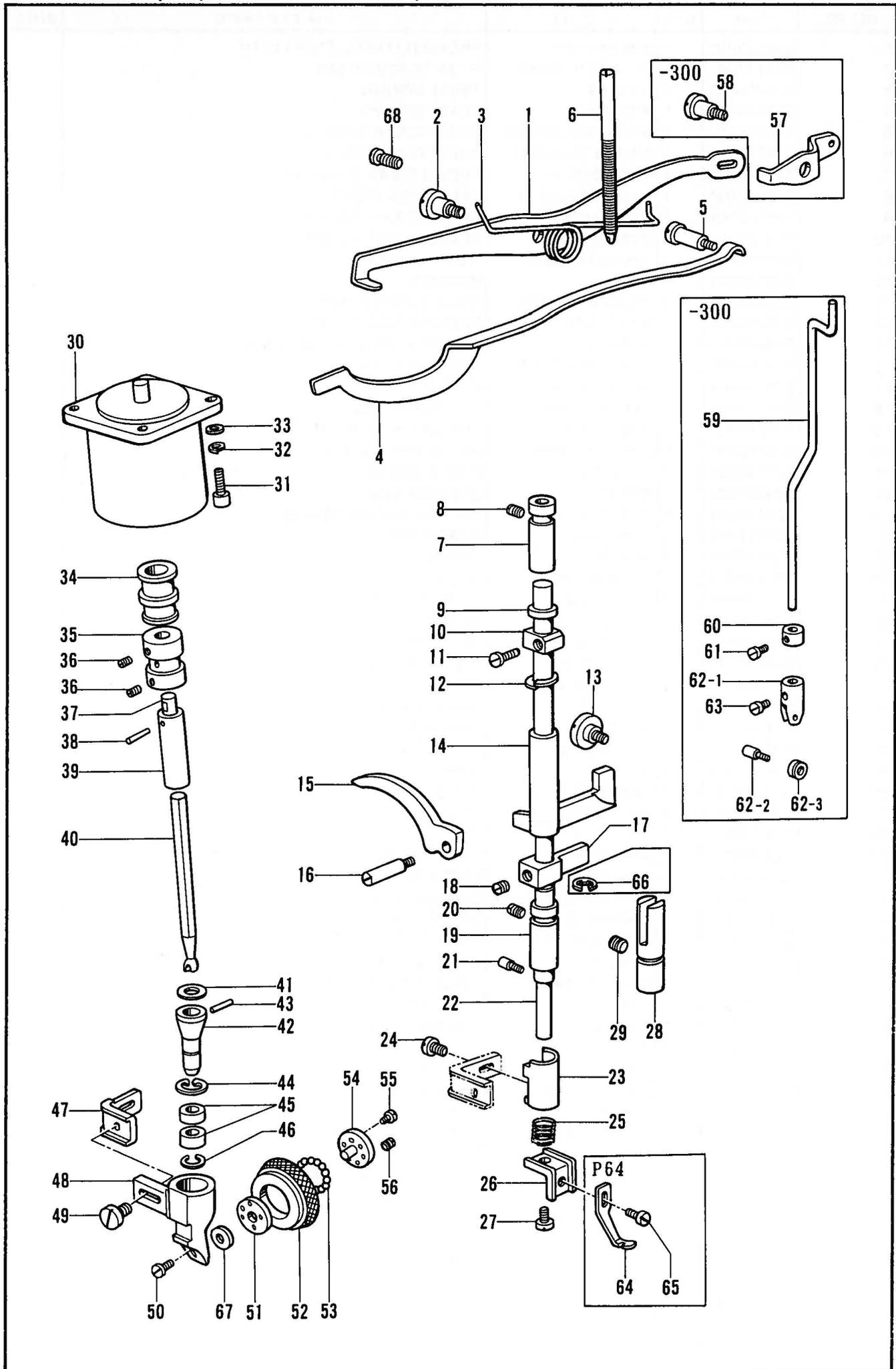
D. 押工関係/Presser foot mechanism/Stoffdrückerfuß/
