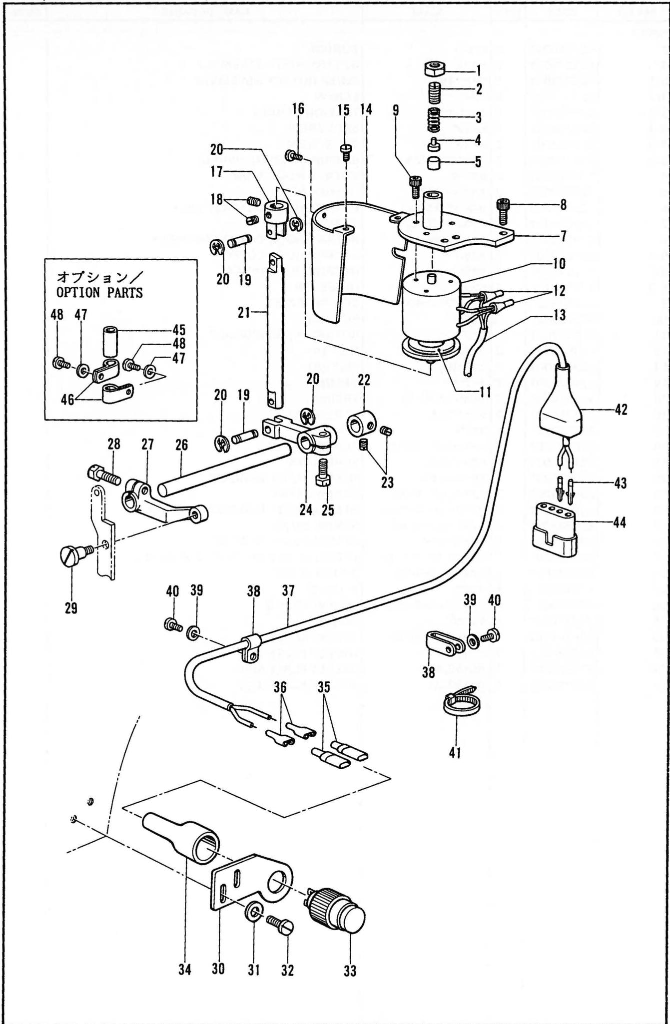
K. タッチバック関係 / Quick back mechanism / Schnellumkehrvorrichtung /
