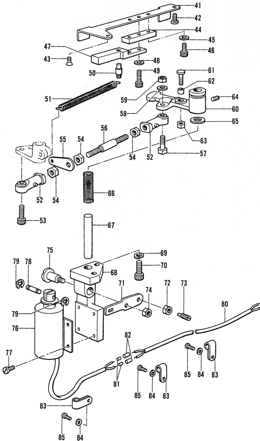
M2. 糸切り関係 / Thread trimmer mechanism / Fadenabschneidevorrichtung /
