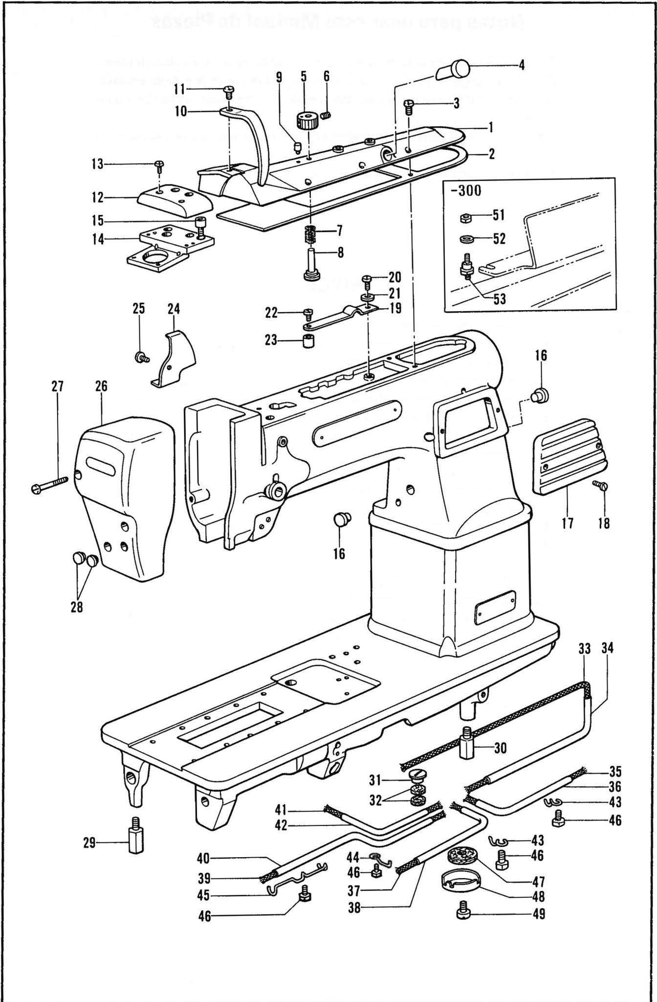
A. 主体関係/Machine body/Maschinengehäuse/
