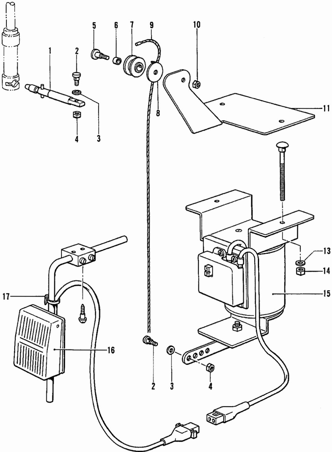
P. 電磁押工上ゲ関係/Presser foot lifting solenoid set/Solenoidsatz für die anhebung des stoffdrückerfußes
