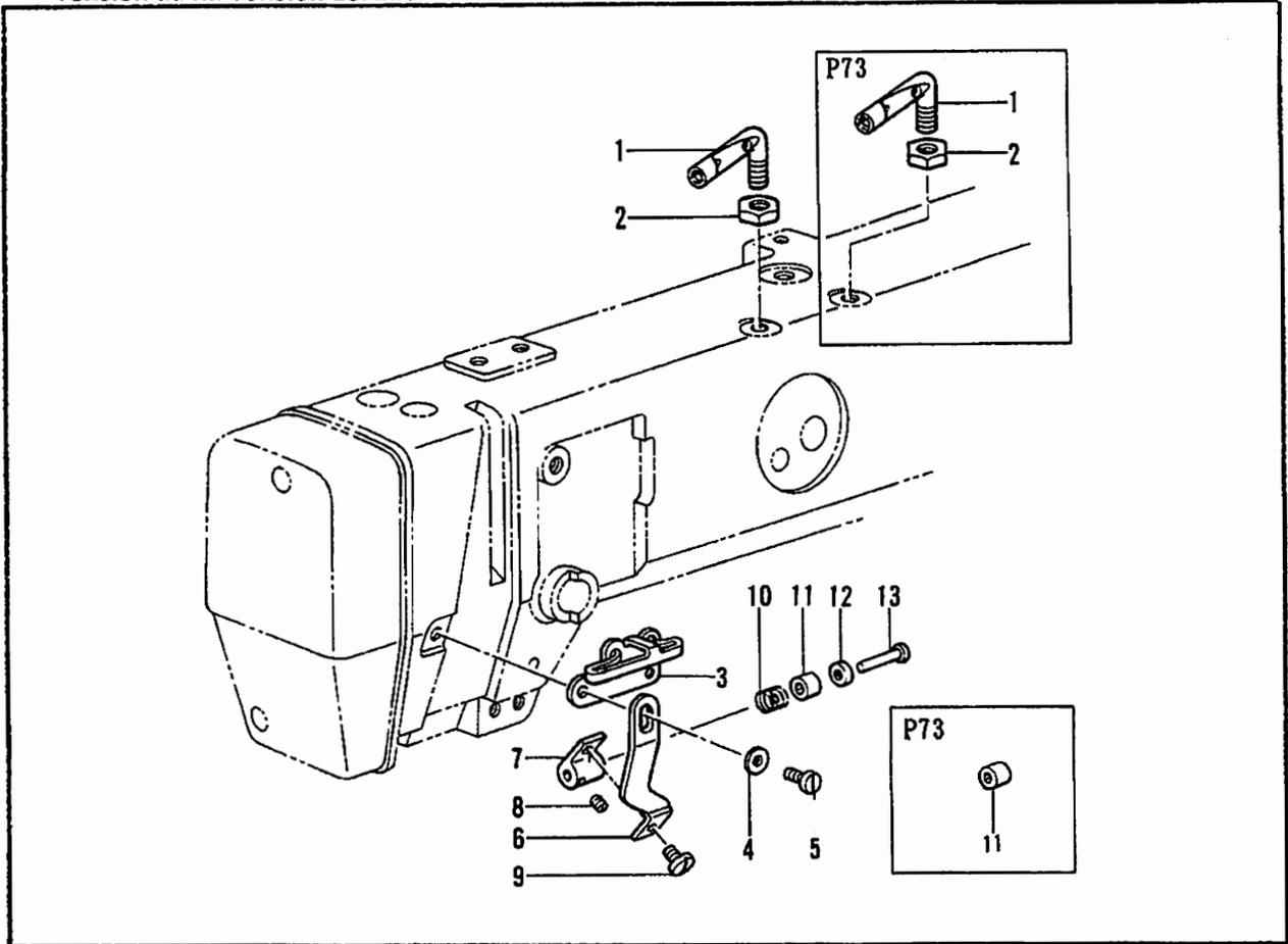
**K2. 糸調子関係(糸切り) / Thread tension (Thread Trimmer) / Fadenspannung (Fadenabschneider) /
