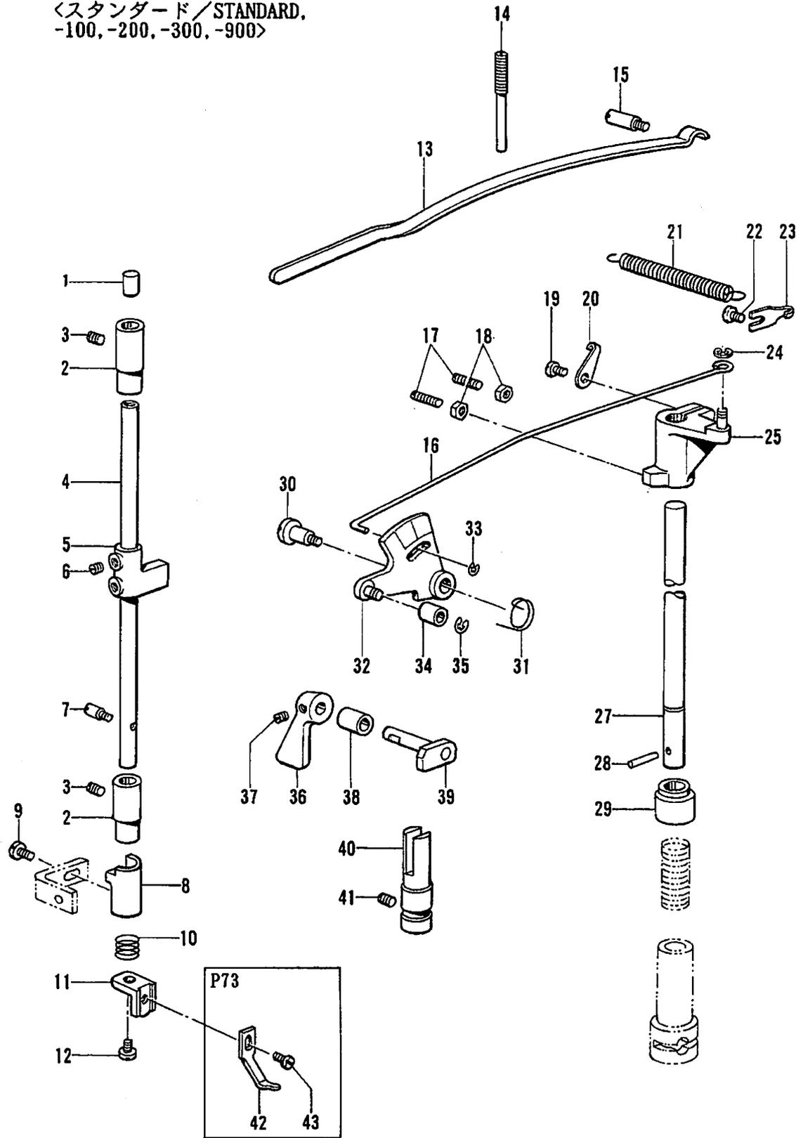
E. 押工関係/Presser foot mechanism/Stoffdrückerfuß/
