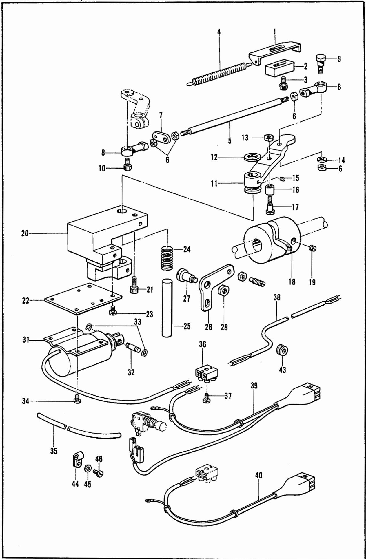
N1. 糸切り関係/Thread trimmer mechanism/Fadenabschneidevorrichtung/
