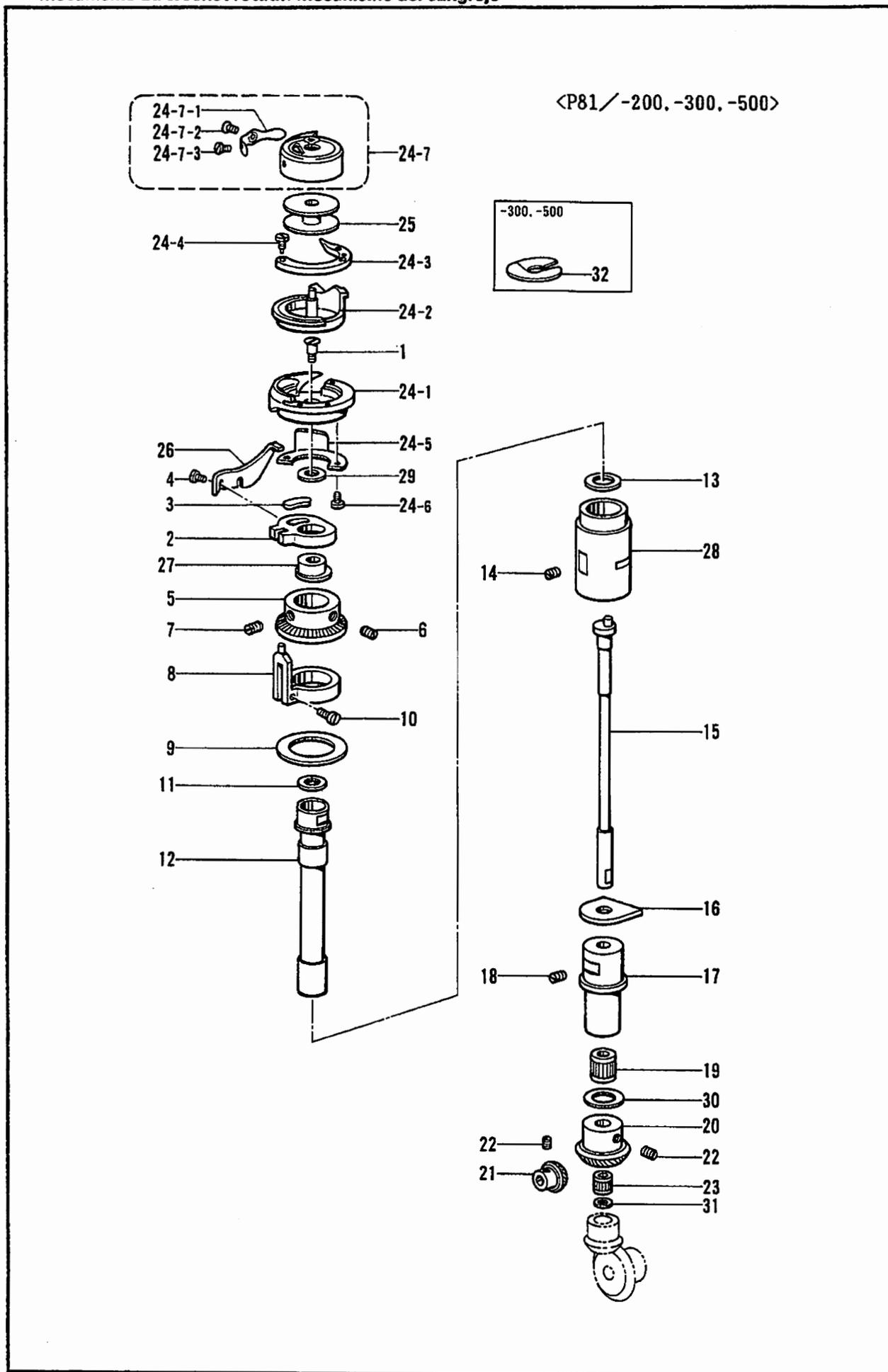
J2. カマ関係/Rotary hook mechanism/Greifervorrichtung/
