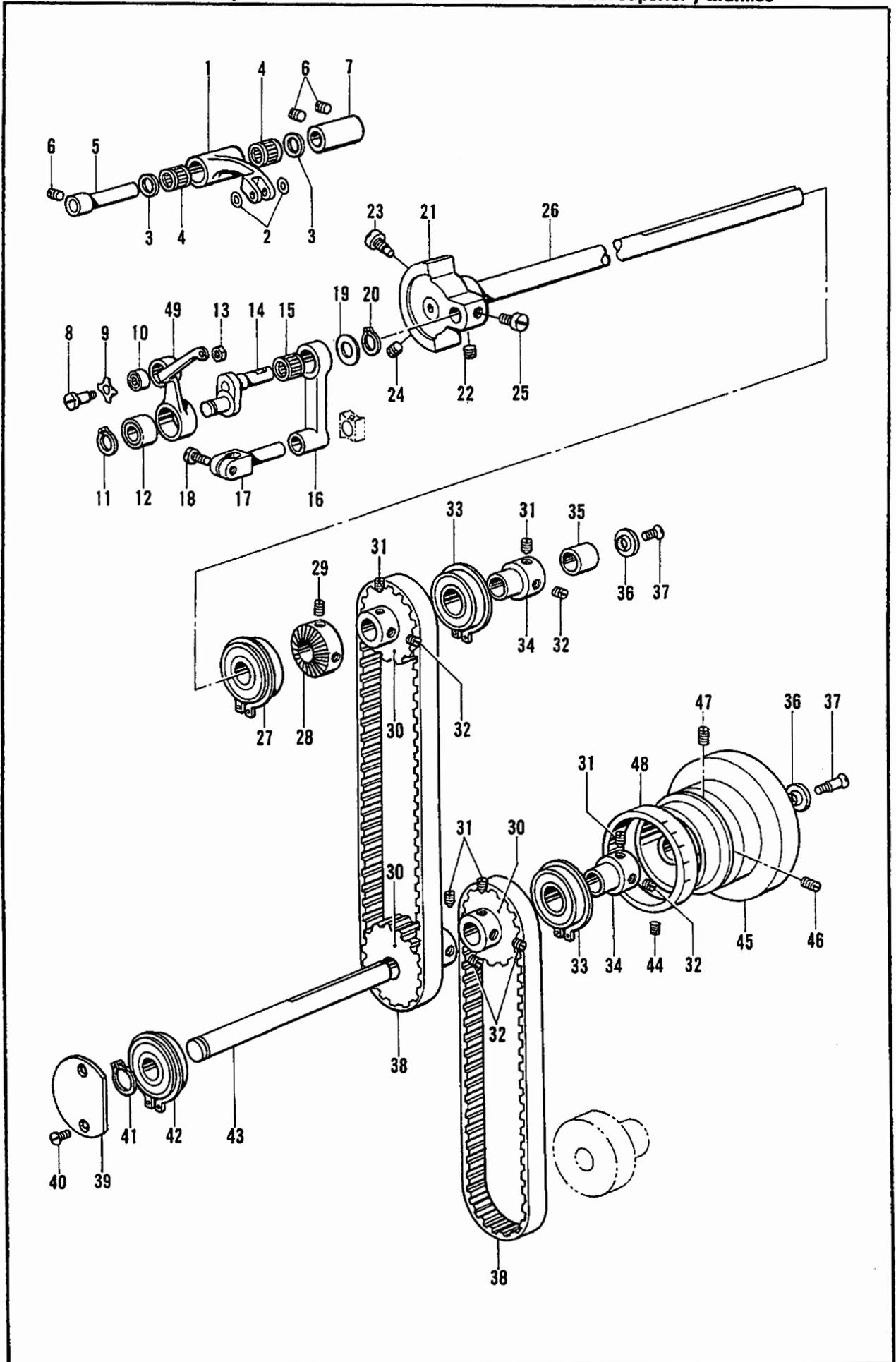
B. 上軸天ビン関係 / Upper shaft and thread take-up mechanism / Obere Welle und Fodenabnahmevorrichtung /
