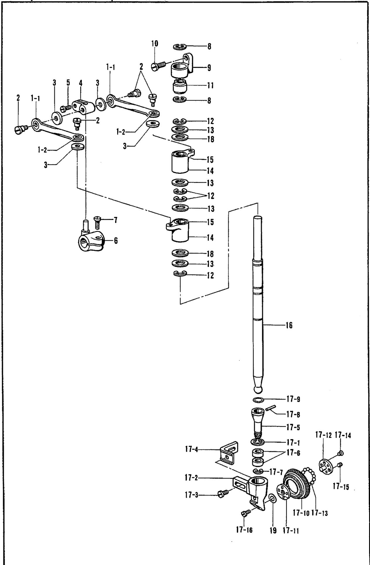
G. ローラー押工関係 / Roller presser foot mechanism / Rollenstoffdruckerfuß /
