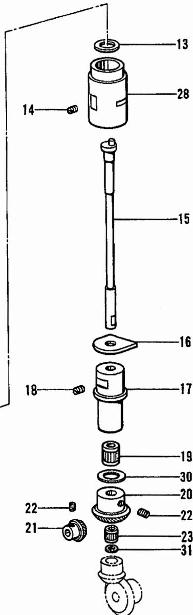
J2. カマ関係/Rotary hook mechanism/Greifervorrichtung/
