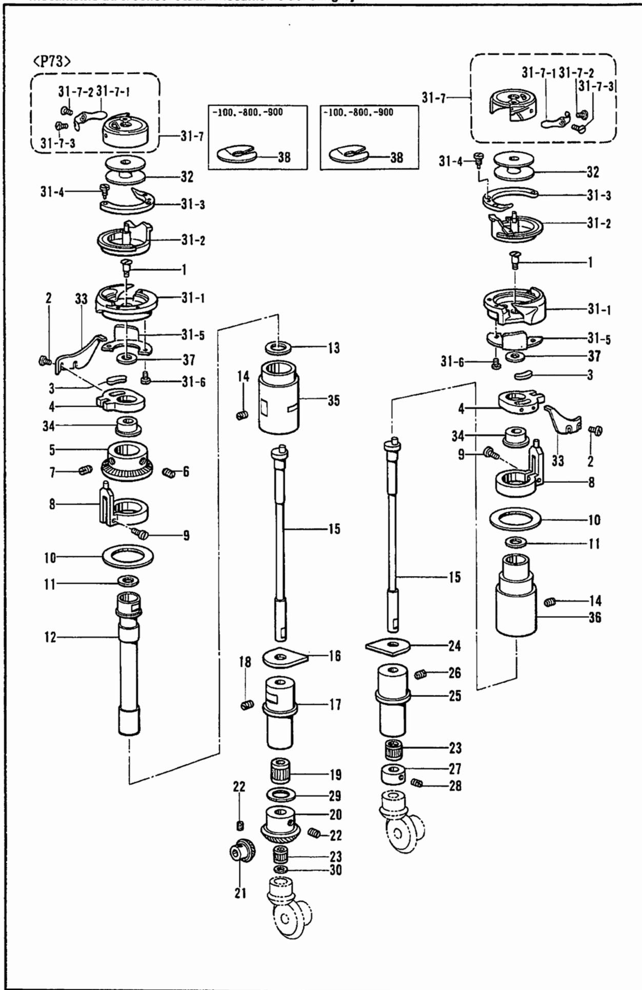
J4. カマ関係/Rotary hook mechanism/Greifervorrichtung/
