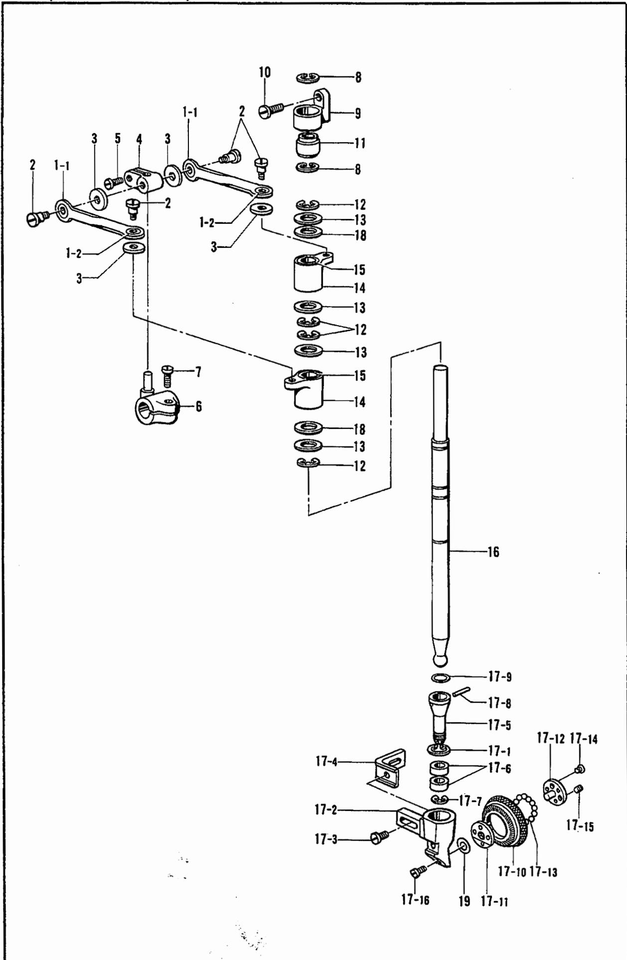
G. ローラー押工関係 / Roller presser foot mechanism / Rollenstoffdrückerfuß /
