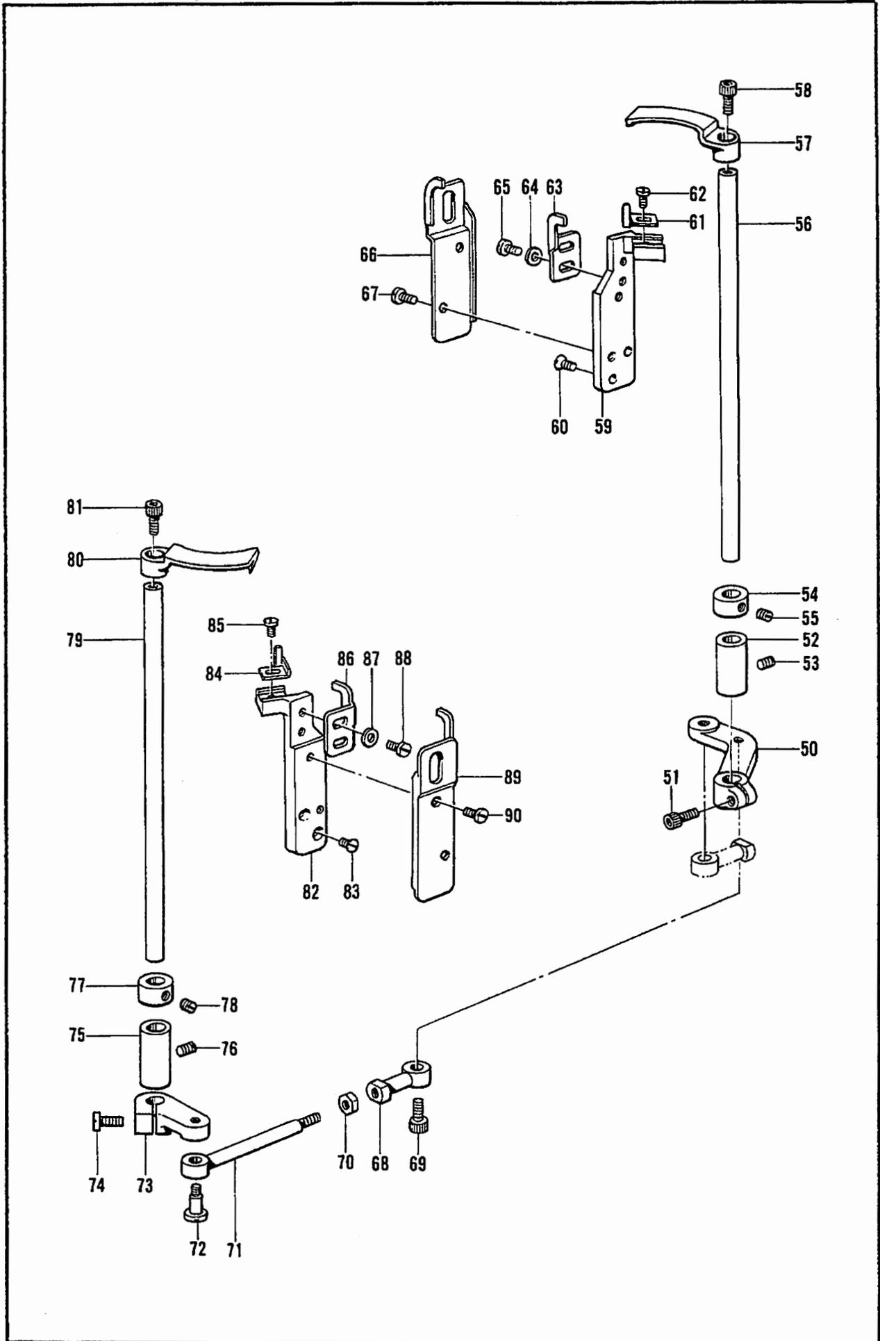
N2. 糸切り関係/Thread trimmer mechanism/Fadenabschneidevorrichtung/
