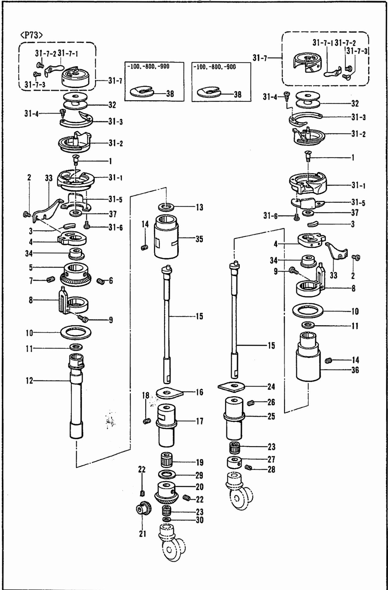
J4. カマ関係/Rotary hook mechanism/Greifervorrichtung/
