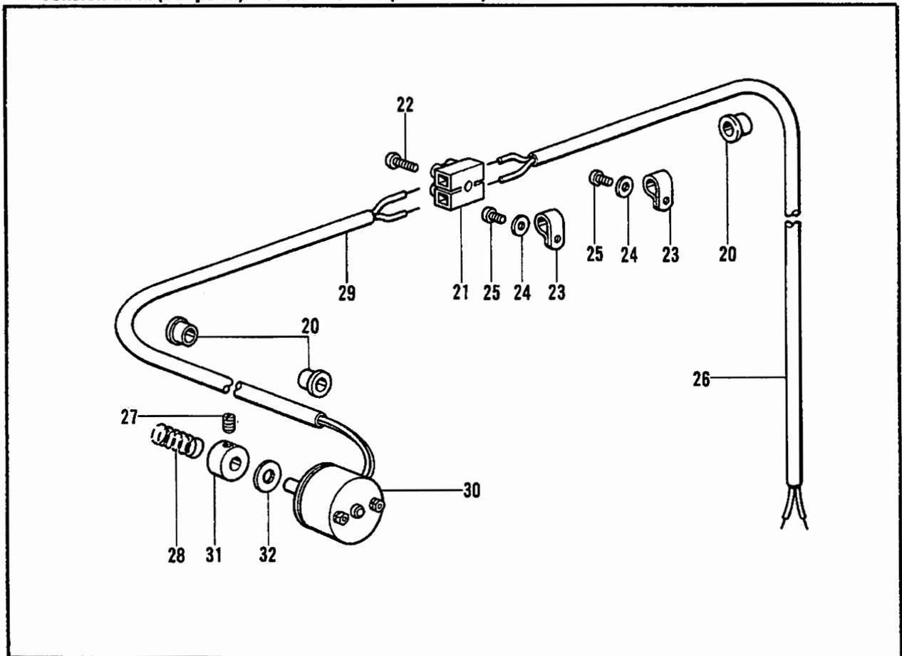
**K1. 糸調子関係 / Thread tension / Faderspannung /
