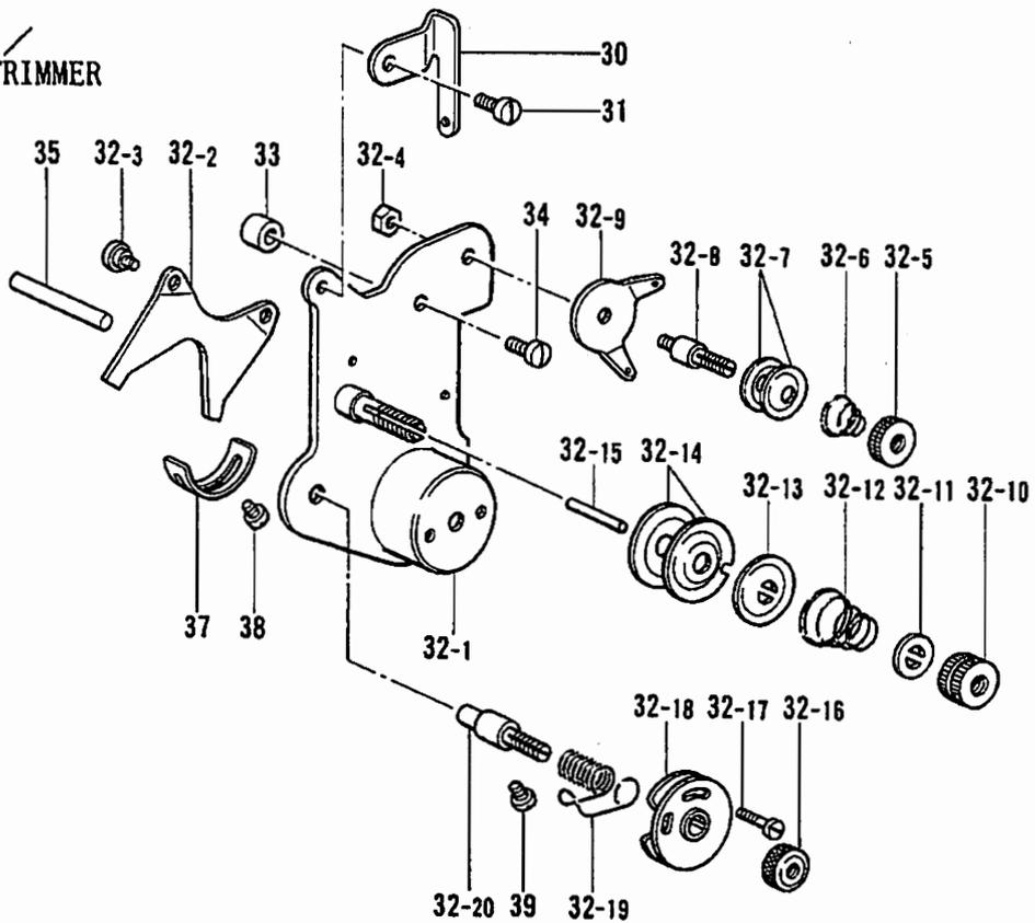
K3. 糸調子関係 / Thread tension / Faderspannung /
