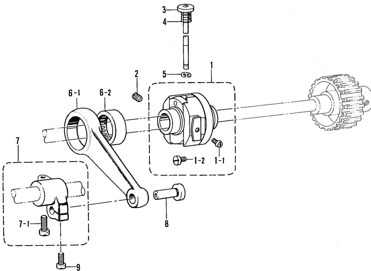
C. 針棒揺動関係/Needle bar rocking mechanism/Nadelstangenbetäigung/
