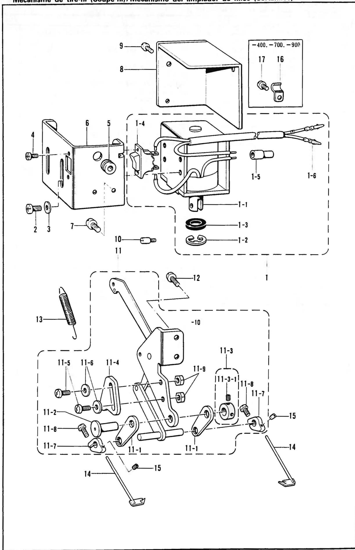
R. 糸扱い関係 (糸切り) / Thread wiper mechanism (Thread Trimmer) / Fadenwischvorrichtung (Fadenabschneider)
