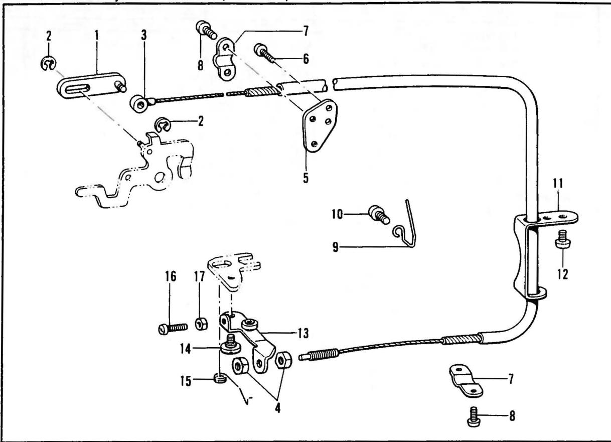
Q. 針位置検出器関係 (糸切り) / Synchronizer (Thread Trimmer) / Synchronisator (Fadenabschneider) /
