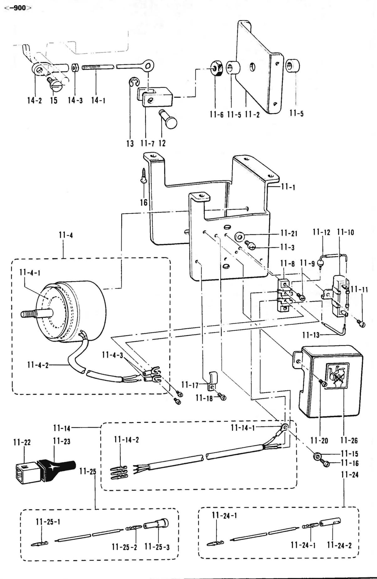
G2. 押工上ヶ関係/Work clamp lifter mechanism/
