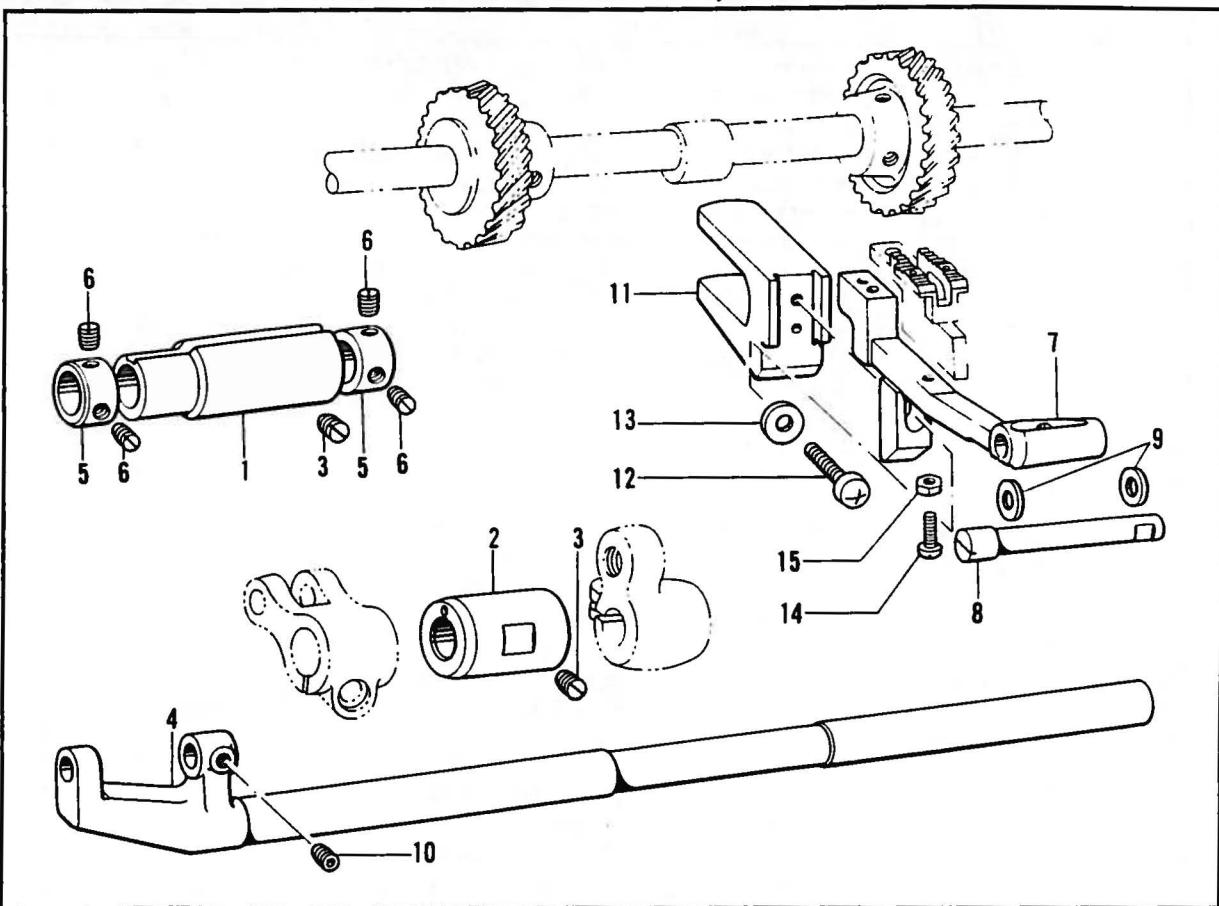
G1. 押工上ヶ関係/Work clamp lifter mechanism/
