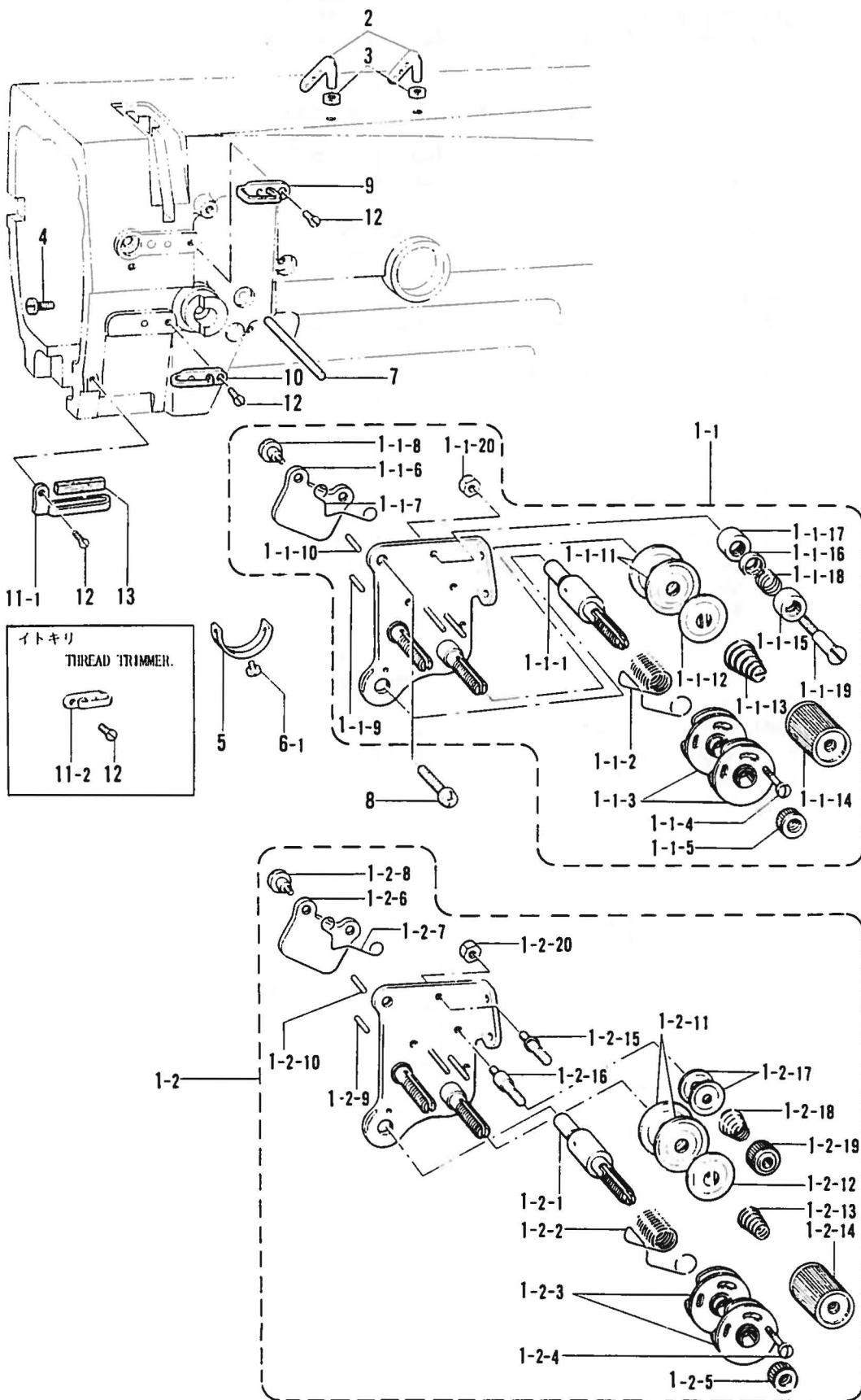
M. 糸通シ関係 / Threading mechanism / Fadenführungs vorrichtung /
