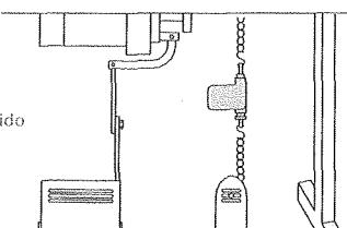
⑦ 接於自動切線針車倒針用電磁電源上 (DC 24 ~ 48V)
