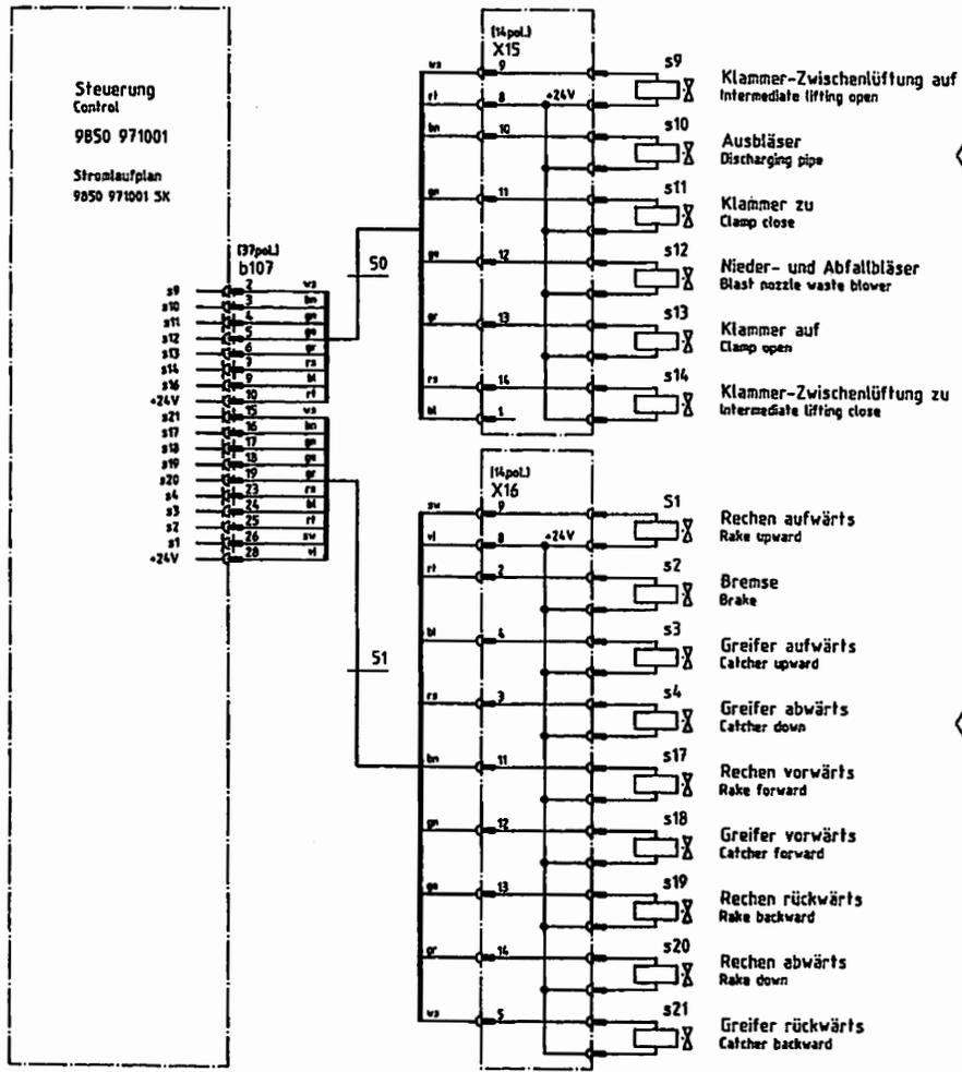
Anschlüsse für Magnetventile Fabrikat "Kuhnke" Typ 95.
