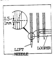
D. LOOSEN THE SCREW OF NEEDLE BAR CLAMP AND ADJUST THE NEEDLE BAR TO GET PROPER HEIGHT.
