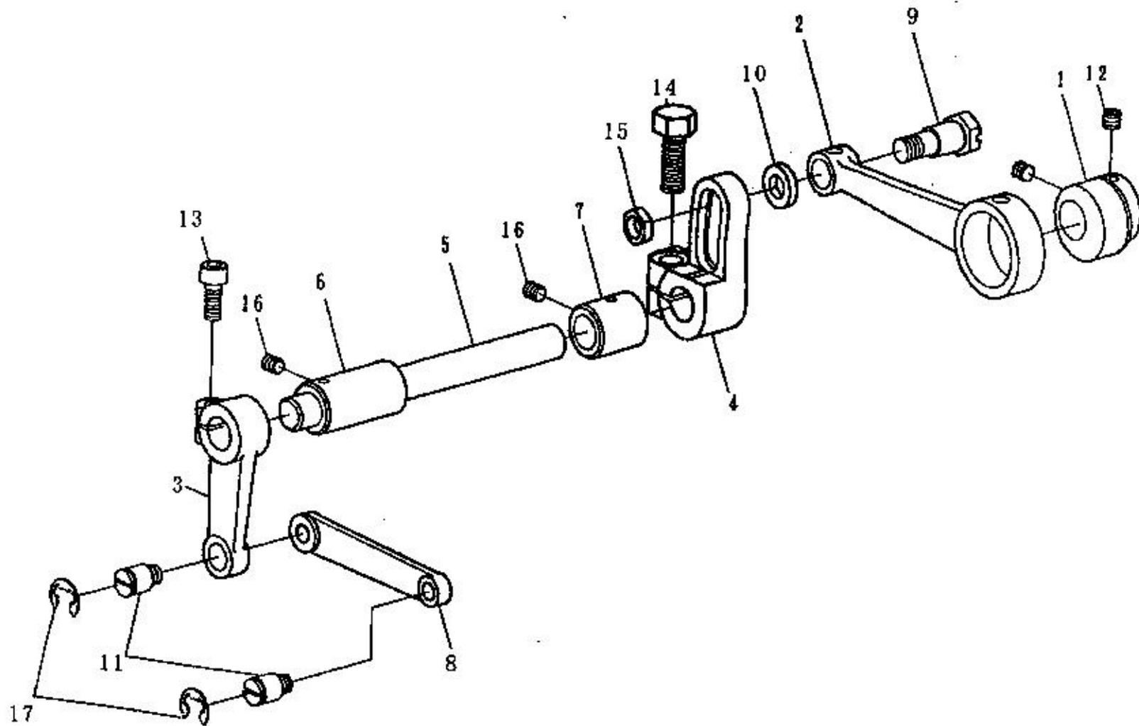
C、针杆·上送料机构 NEEDLE BAR · UPPER FEED MECHANISM COMPONENTS
