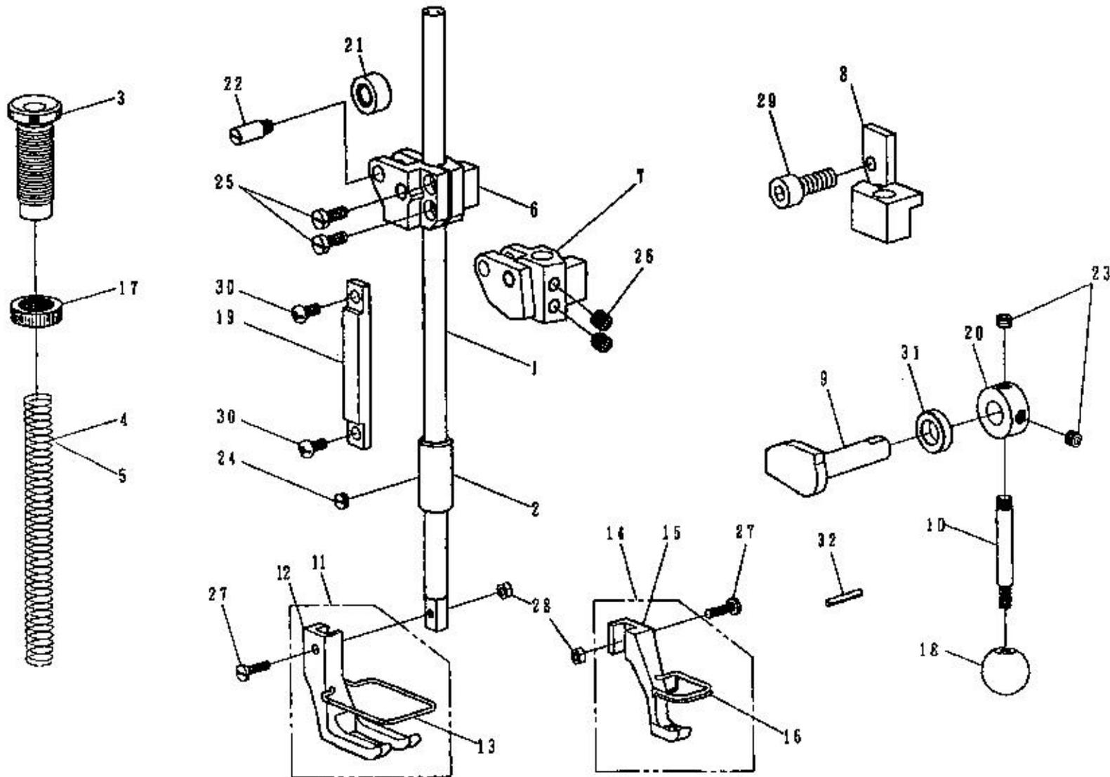
D、压脚机构 PRESSURE BAR COMPONENTS
