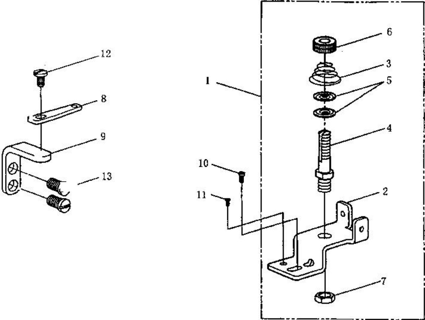
H、夹线器 穿线机构 THREAD WINDER & THREAD GUIDE COMPONENTS (2/2)
