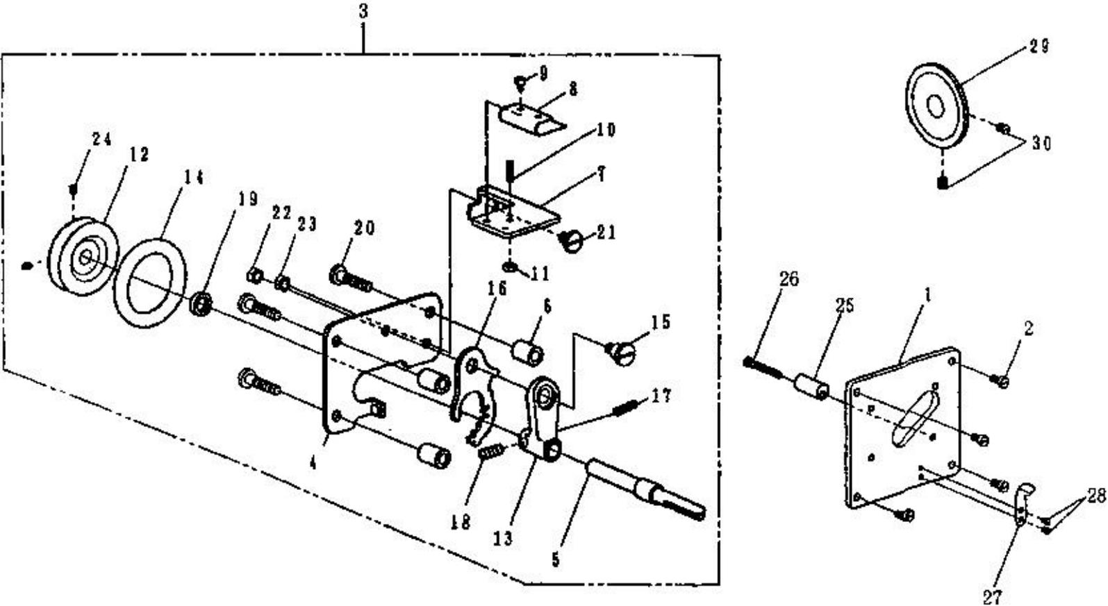
H、夹线器 穿线机构 THREAD WINDER & THREAD GUIDE COMPONENTS (1/2)
