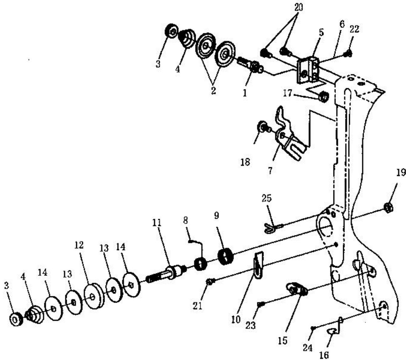
G、夹线器机构 TENSION POST COMPONENTS
