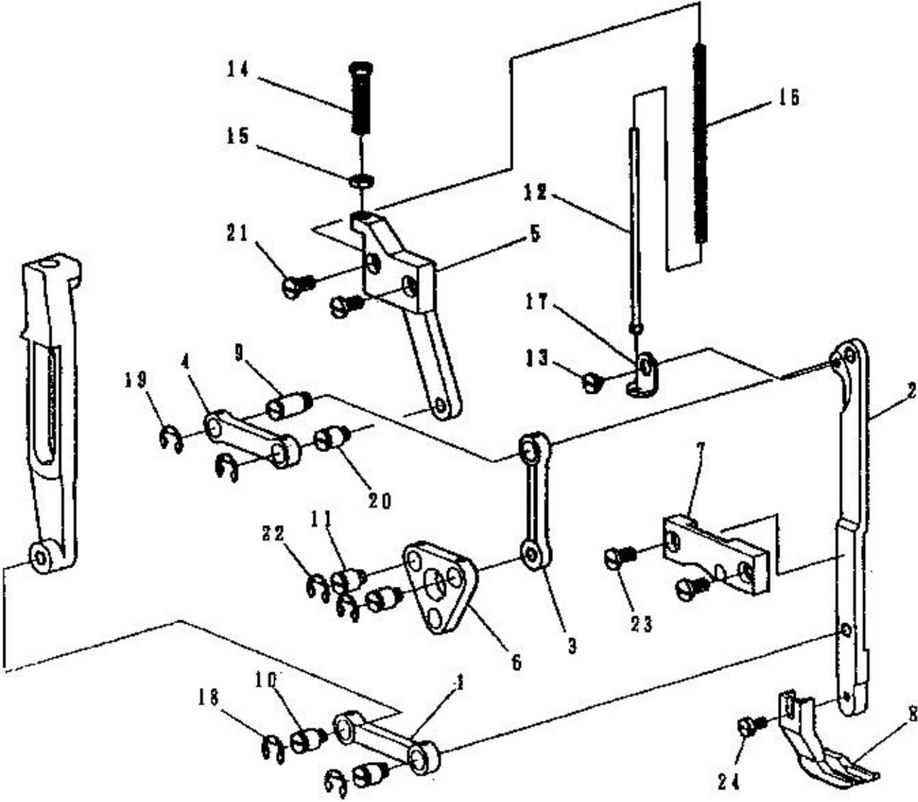
C、针杆·上送料机构 NEEDLE BAR·UPPER FEED MECHANISM COMPONENTS
