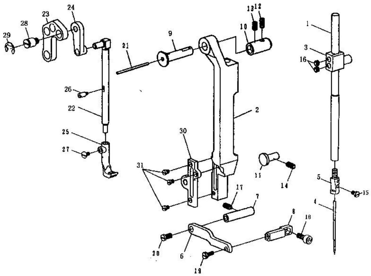
C、针杆·上送料机构 NEEDLE BAR · UPPER FEED MECHANISM COMPONENTS
