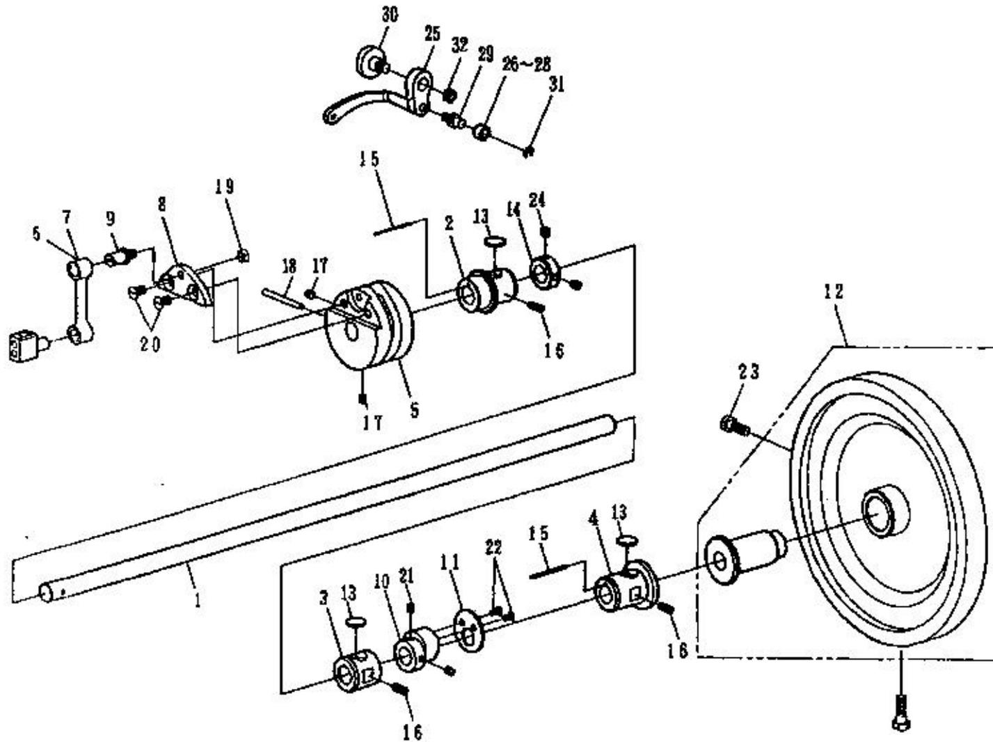
B、上轴机构 MAIN SHAFT COMPONENTS
