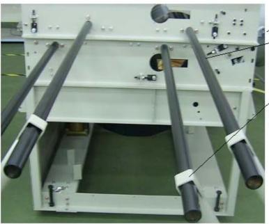
ベルト交換用バイブ -更换皮帯用套管 Pipe for belt exchanging
