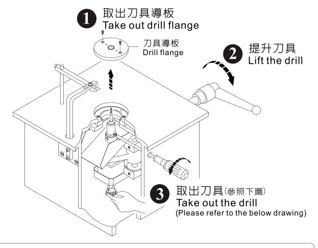
用手移動轉軸找尋固定刀具的螺絲孔(手請由抽屜孔伸入至馬達下方轉軸,如圖3-1), 放鬆螺絲(如圖3-2),再取出刀具(如圖3-3,3-4,3-5)
