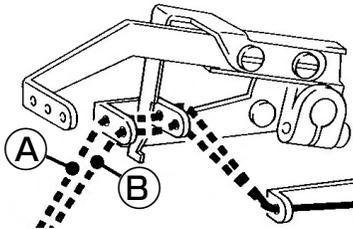
Wenn Legefaden zu lose liegt, Einfädung nach der gestrichelten Linie ① vornehmen. Wenn der Legefaden weiterhin zu lose liegt, Einfädung nach der gestrichelten Linie ② vornehmen.
