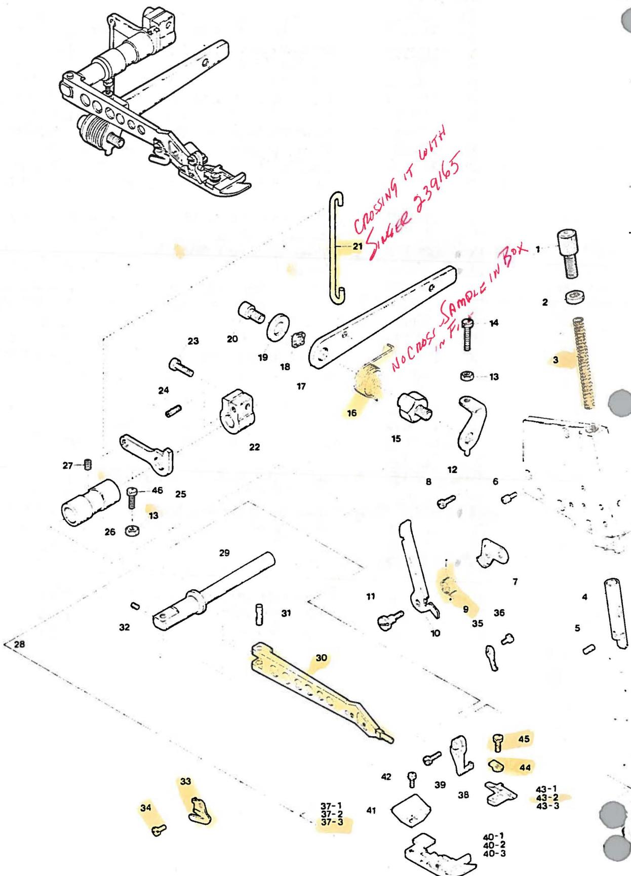
PRESSER FOOT MECHANISM押工機構
