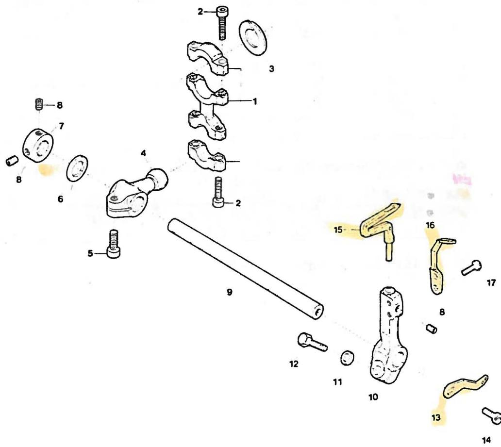
LOWER LOOPER DRIVING MECHANISM下ルーパ機構
