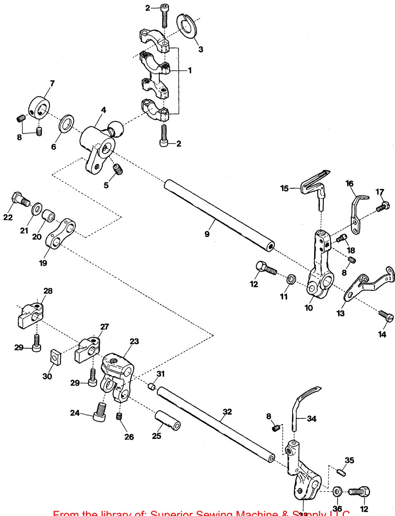
LOWER & DOUBLE CHAINING LOOPER DRIVING MECHANISM 下ルーパ及び二重環ルーパ機構 10
